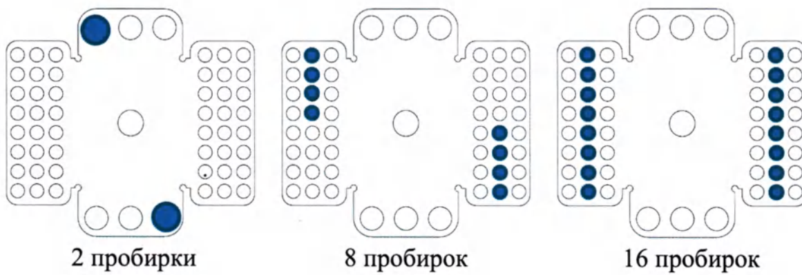
Схема 1. Примеры симметричного расположения пробирок в роторе
