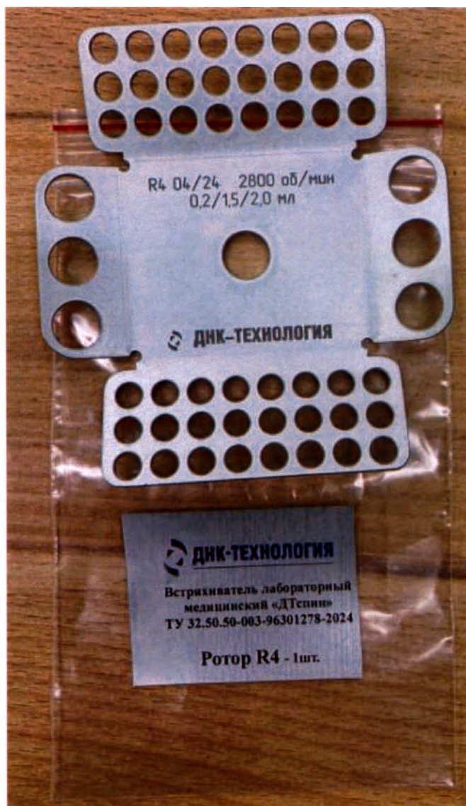
Ротор R4 для 6 стрипов 8x0,2 мл и 6 микропробирок 2,0/1,5 мл
