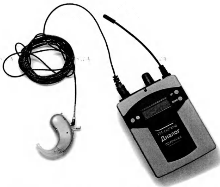
Рисунок 31 - Подключение слухового аппарата к FM-адаптеру при помощи аудио-шнура
