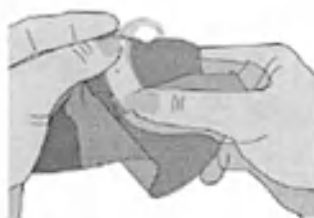
Рисунок 32 - Очистка слухового аппарата.
