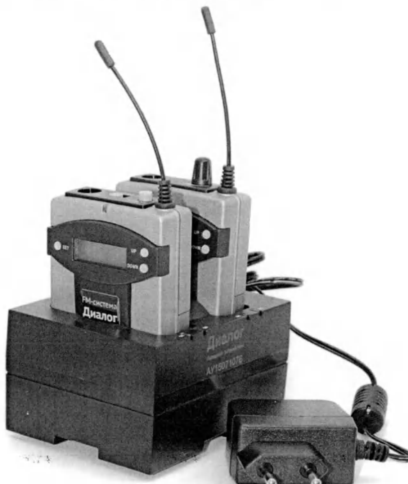
Рисунок 20 - Зарядное устройство для FM-адаптера и FM-передатчика
