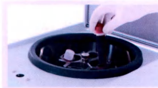
Рис.4: Установка пробирки в центрифугу DUOGRAFTER II с пробиркой-противовесом
