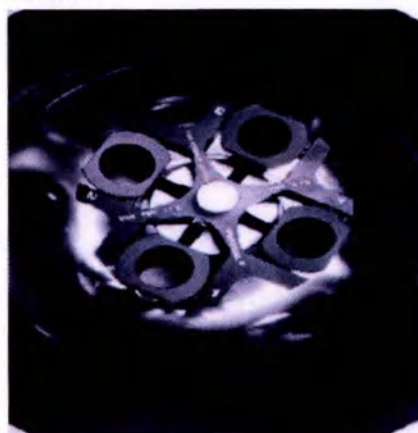
Рис. 3: Правильное расположение ротора и адаптеров для пробирок
