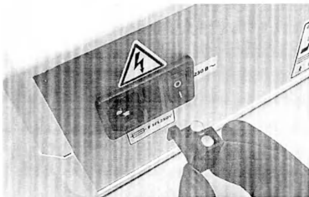
Рис. 35. Извлечение предохранителя из корпуса Apparata
