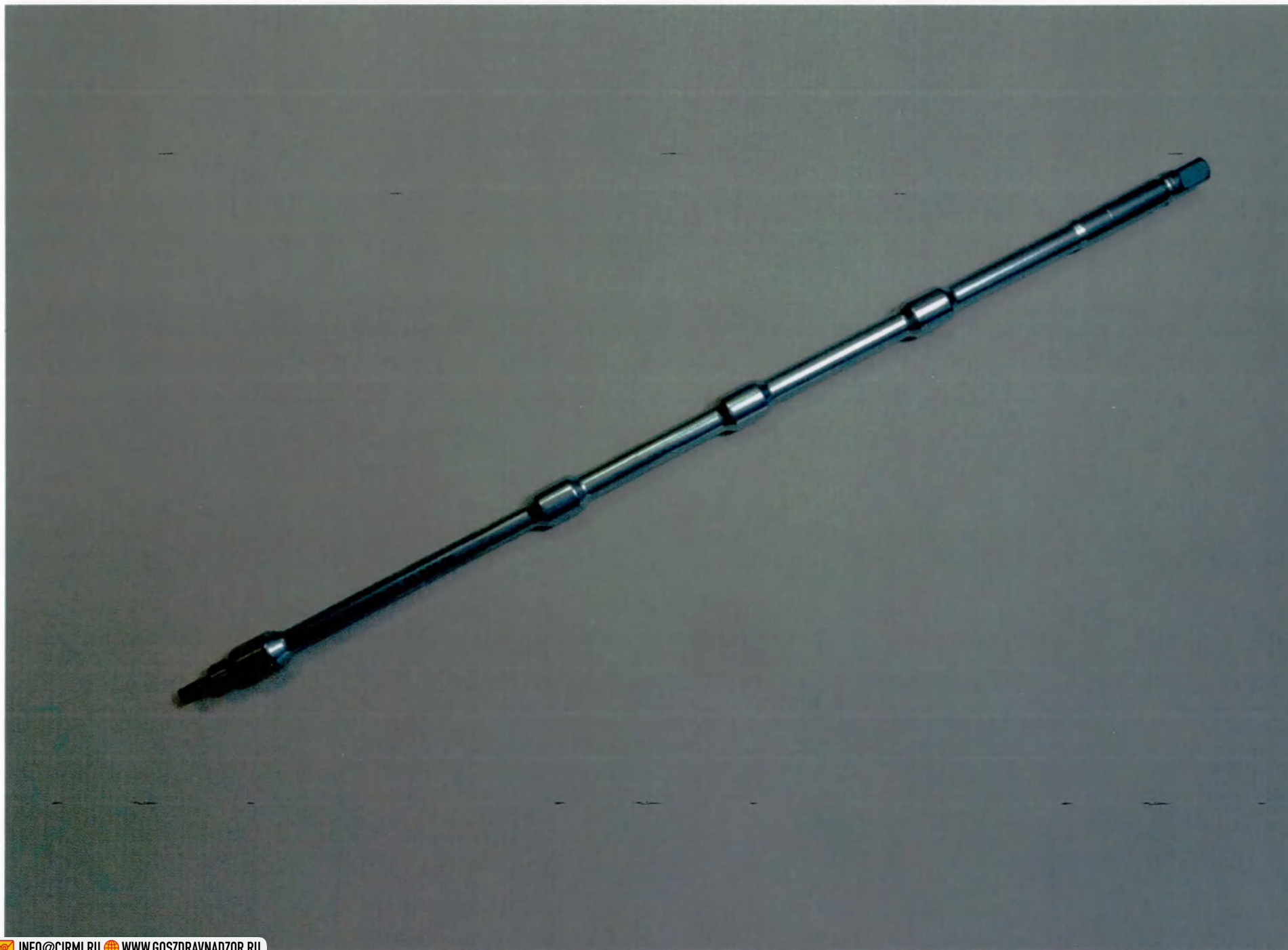
Рисунок 45. ОИ 04.22.000.00 Стержень ревизионной отвертки. Общий вид.
