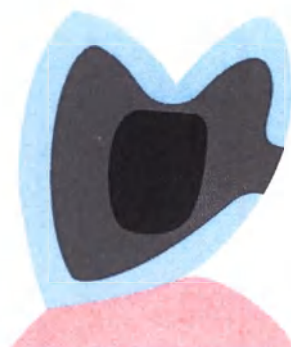
Удвоенная высота перемычки при обычной ширине = восьмикратная стабильность
