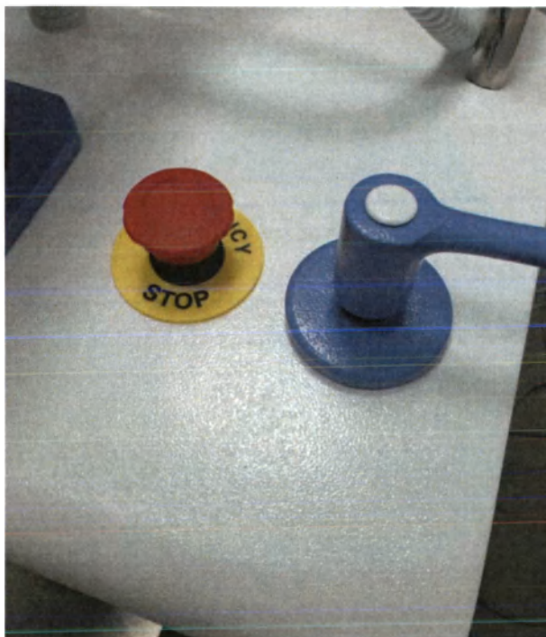
Рисунок 19 Расположение кнопки АВАРИЙНОЙ ОСТАНОВКИ на штативе С-дуга
