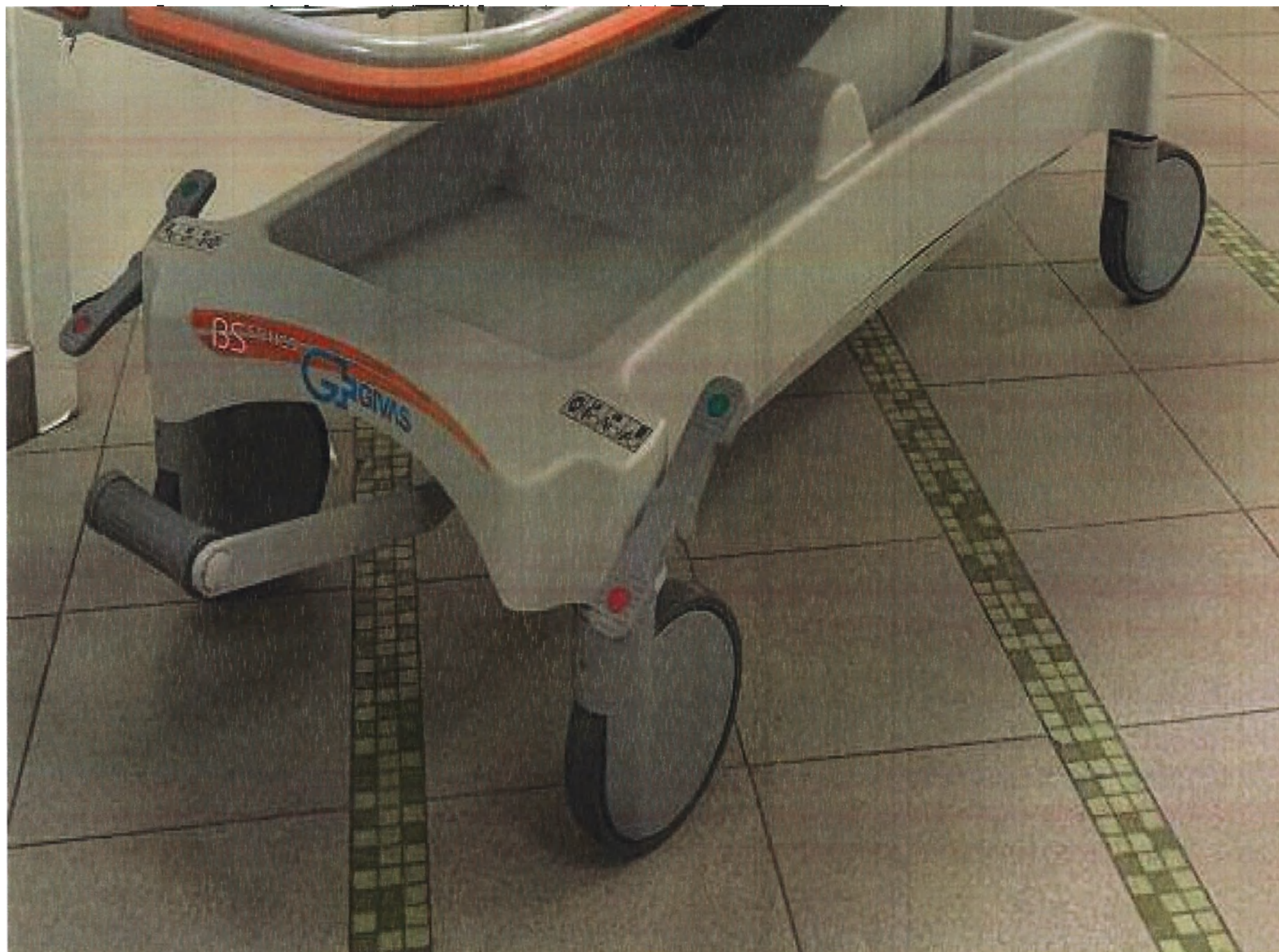
7. Колесное основание из 4-х колес Ø 200 мм
