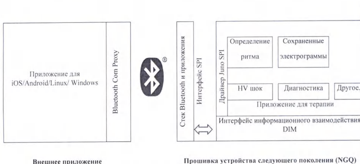
Рисунок С. Архитектура встроенного программного обеспечения NGQ
