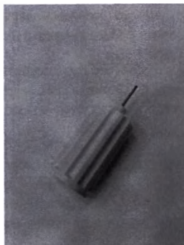
Рисунок 7. Внешний вид Отвертки с тарированным усилием
