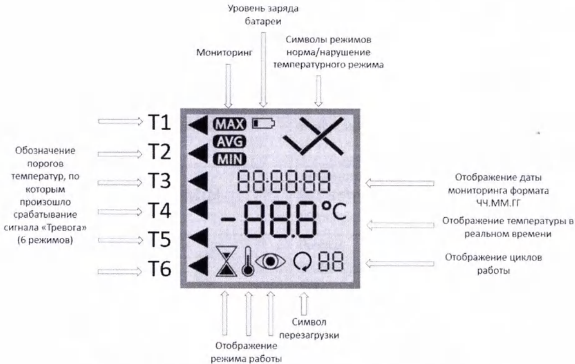
Рисунок 3.3.3 – Дополнительные комментарии к рисунку 3.3.2 Таблица 3.3.1 - Информация о работе ЖК дисплея
