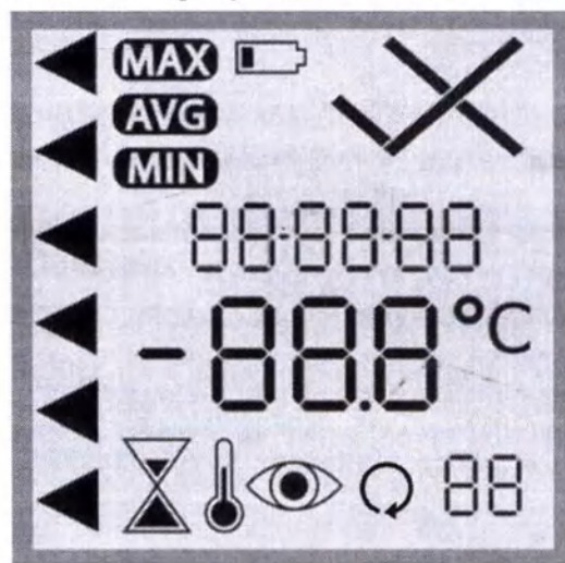
Рисунок 3.3.2 – Макет символов на ЖК дисплее
