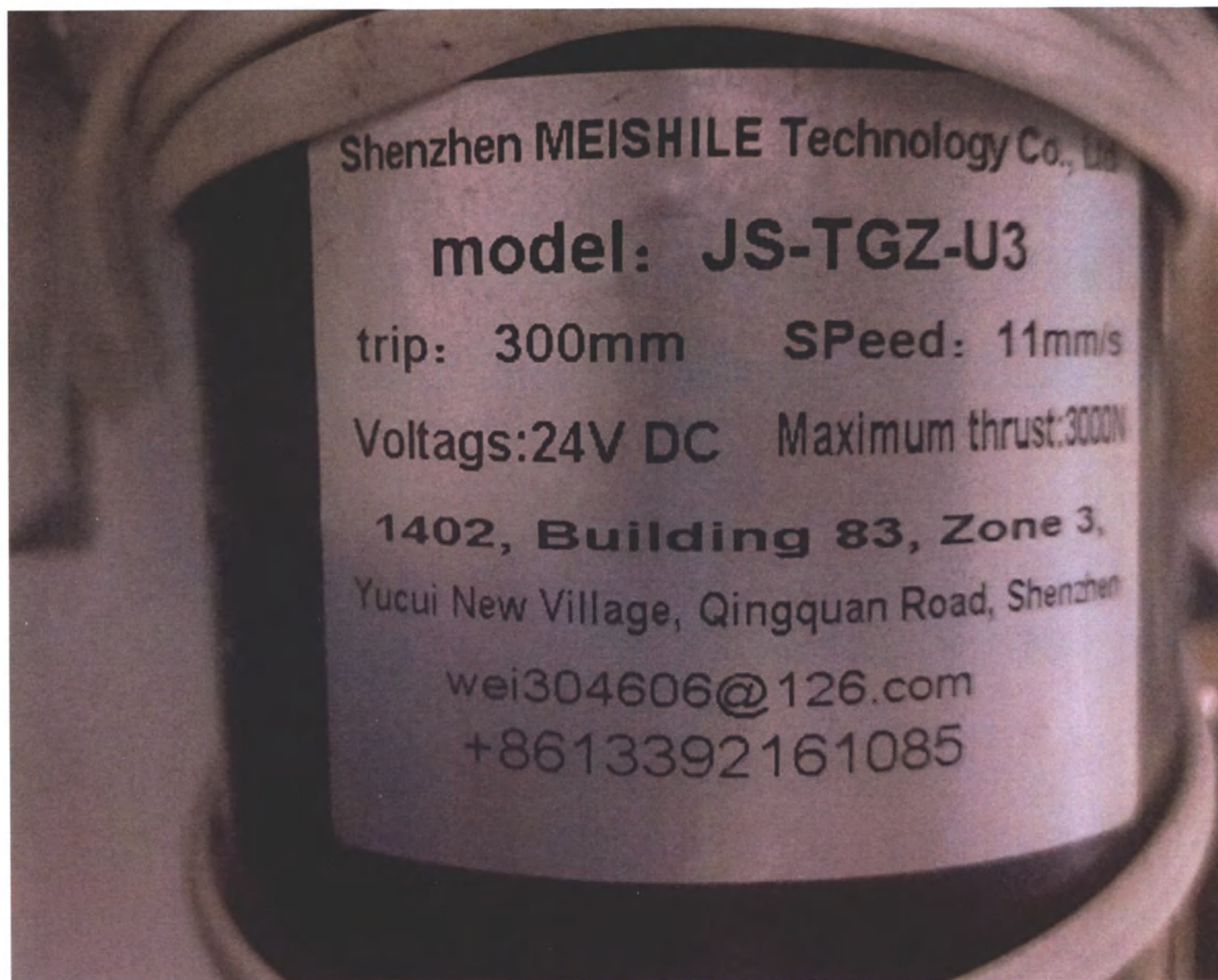
Фото 10. Пример маркировки рабочей части электропривода
