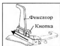
Рисунок 26 а. Фиксирующее устройство ММ-Л01. Блокировка
