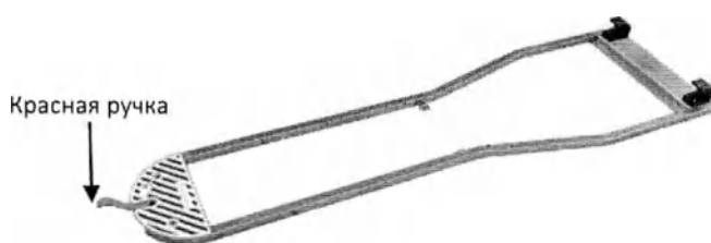
Рисунок 28. Фиксирующее устройство ММ-Л04.Разблокировка
