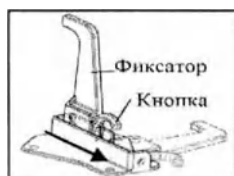
Рисунок 26б. Фиксирующее устройство ММ-Л01.Разблокировка
