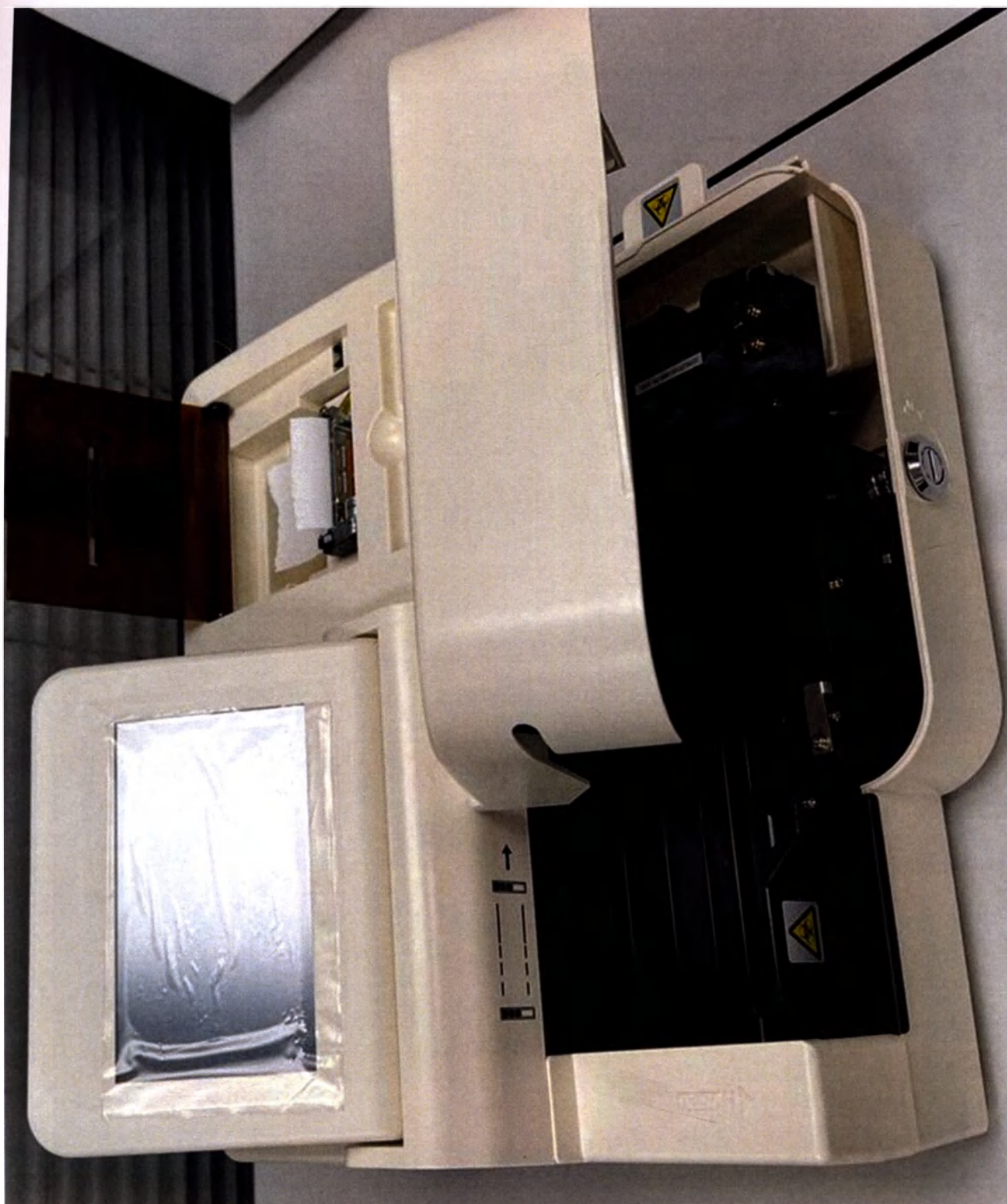
Рисунок 2 – Анализатор. Вид спереди с открытой передней крышкой и открытой крышкой термопринтера
