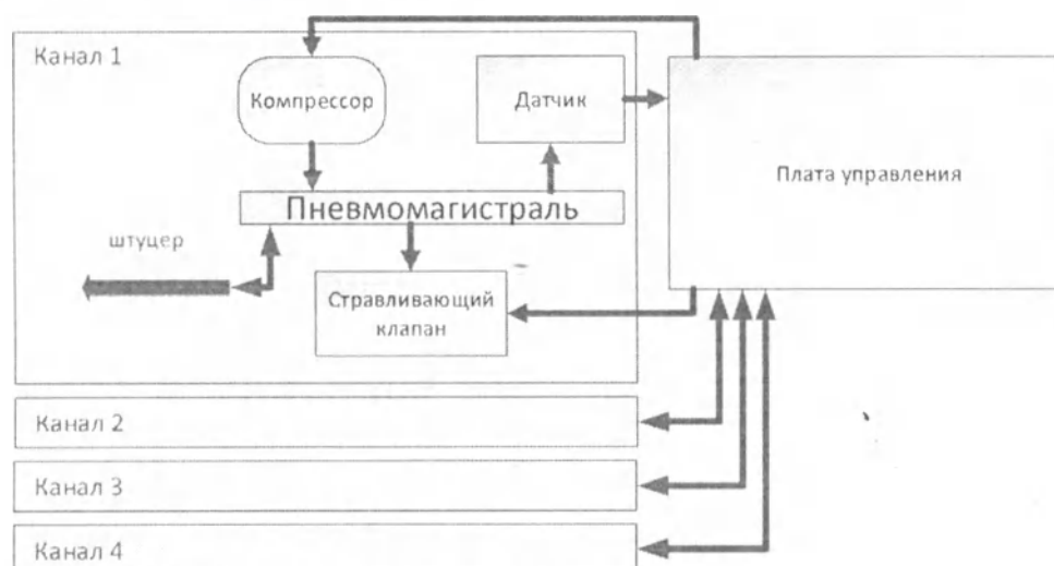
Рис. 14. Структура четырехканального измерительного модуля
