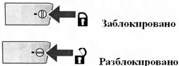
Рисунок 7- Положение винта блокировки на крышке отсека элемента питания.
