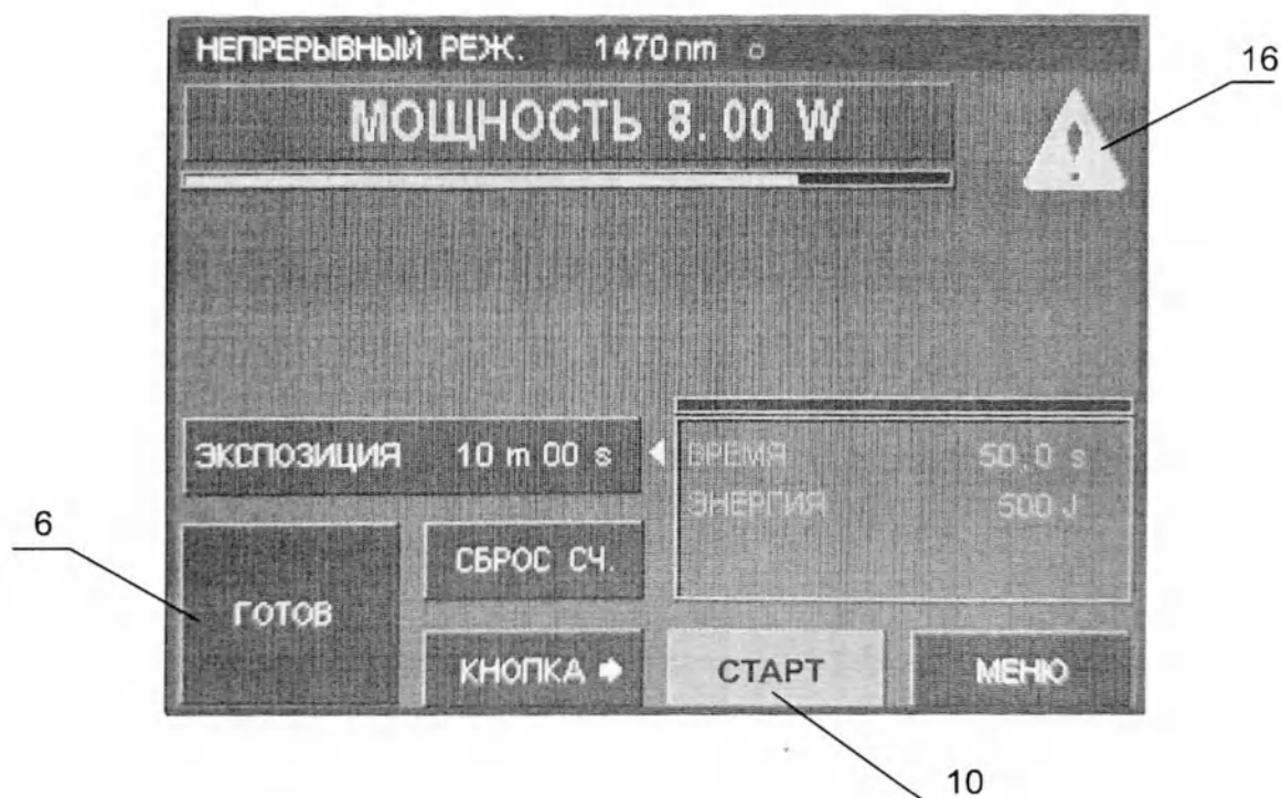
Рис.13. Вид экрана при нажатой кнопке ПОДГОТОВКА.
