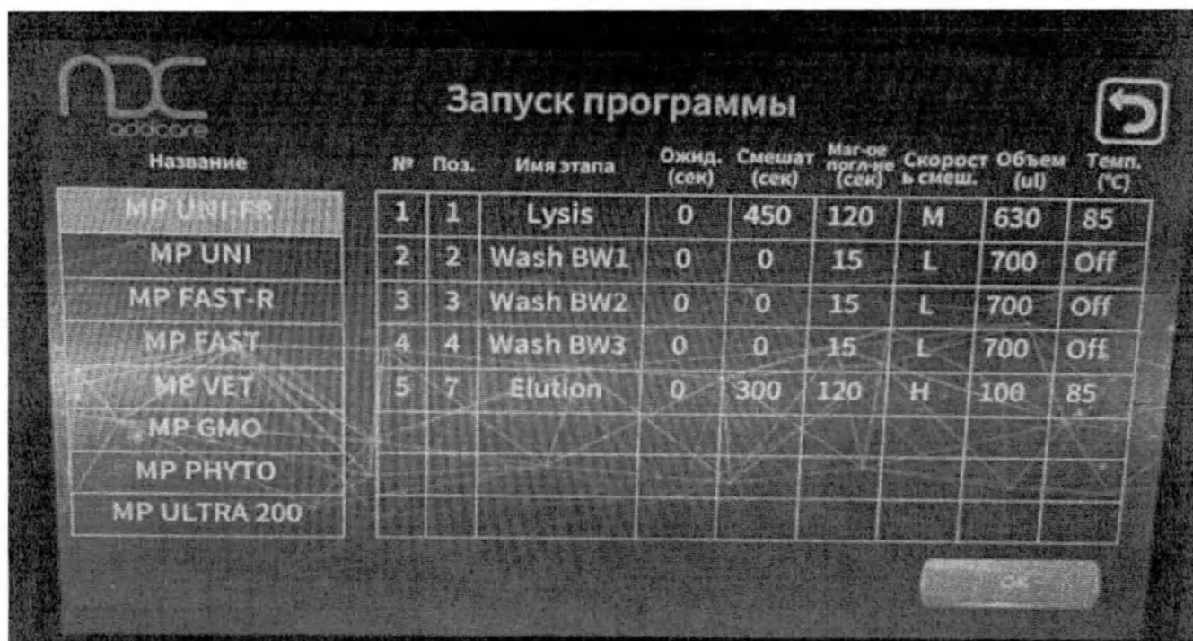
Рис. 10. Интерфейс при нажатии запуска нужной программы Названия программ в левой части интерфейса, а выполняющиеся шаги выбранного теста - с правой. При выборе «ОК» интерфейс будет отображаться, как показано ниже. Отображается название теста и текущий шаг.
