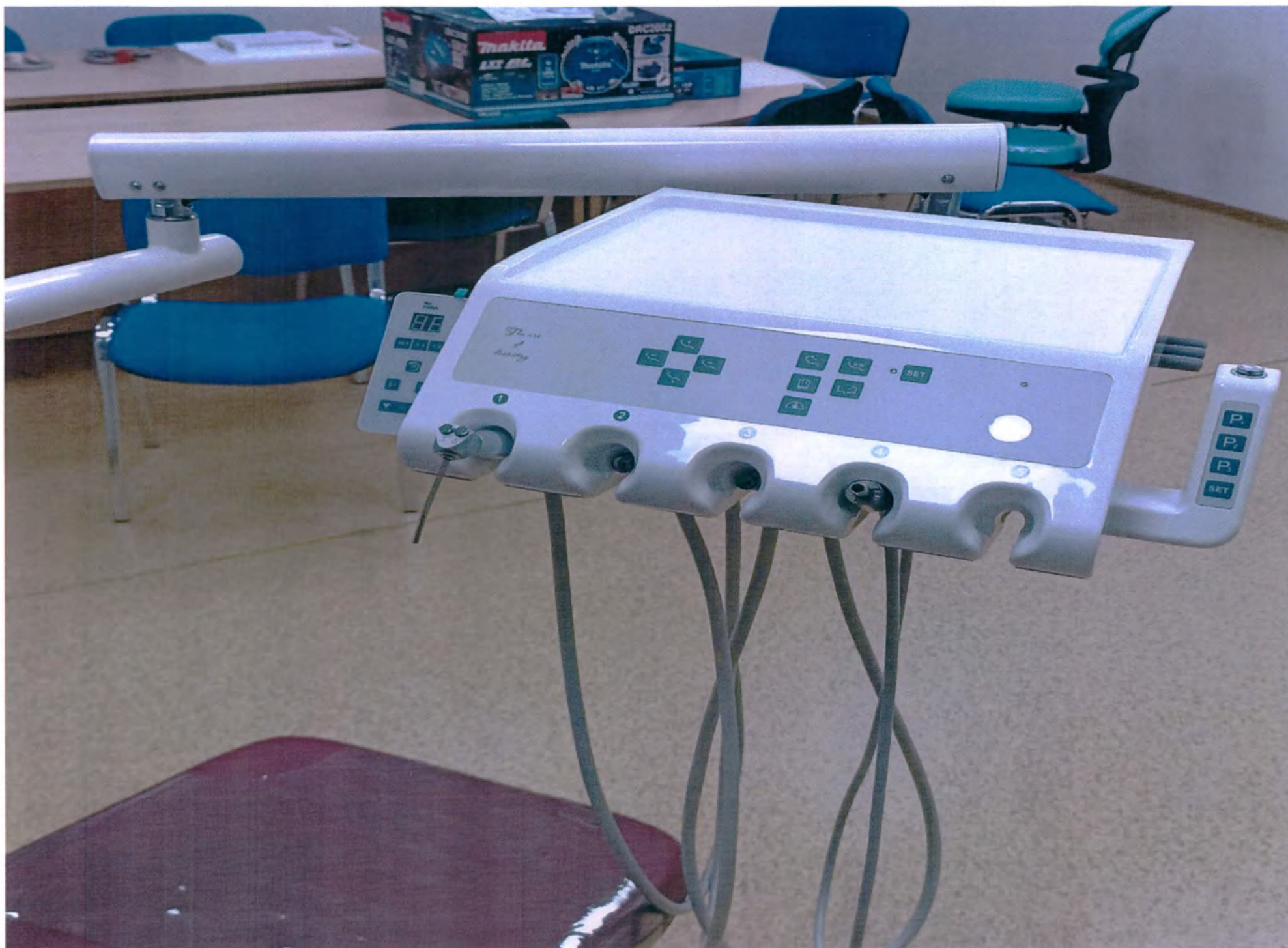
Фото 6. Модуль стоматолога на пять инструментов с нижней подачей шлангов на пантографическом плече.
