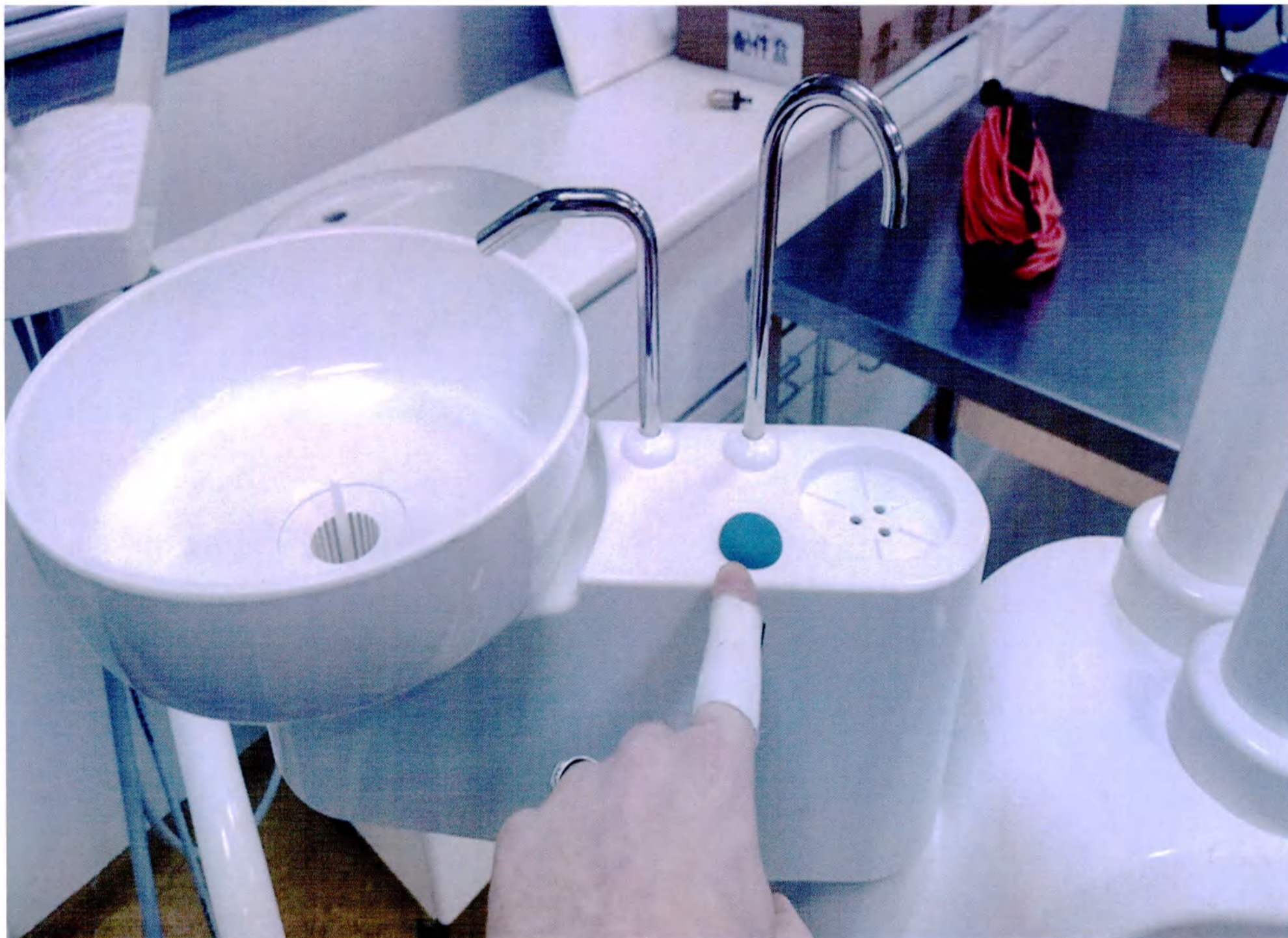
Фото 9. Модуль гидроблока с Плевательницей меламиновой, Трубкой для наполнения стакана, Трубкой для смыва плевательницы Установки стоматоло-
