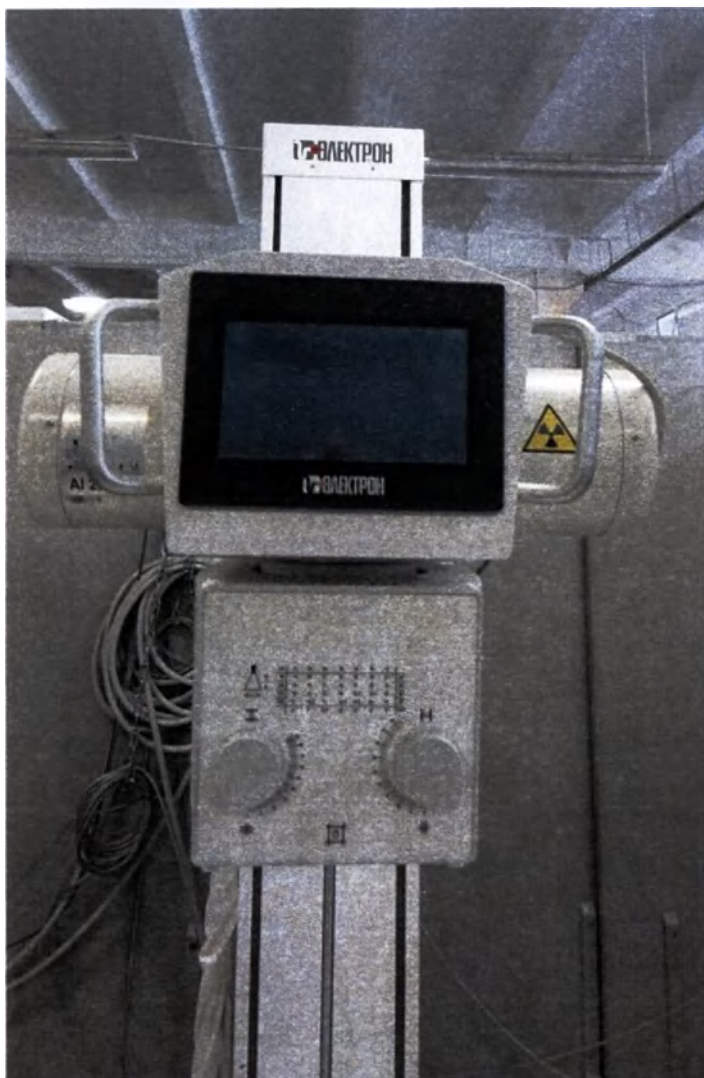
Фотография 11 – Кронштейн с излучателем в сборе RTOMO-10, по спецификации в варианте комплектности с коллиматором серии Ralco и и излучателем рентгеновским серии Roesys
