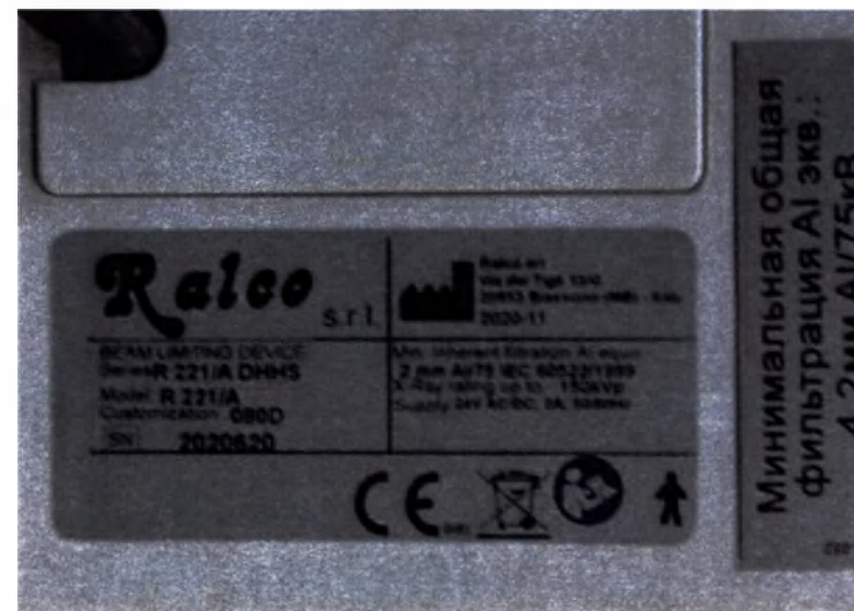
б) - Пример маркировки коллиматора серии R 221/A DHHS
