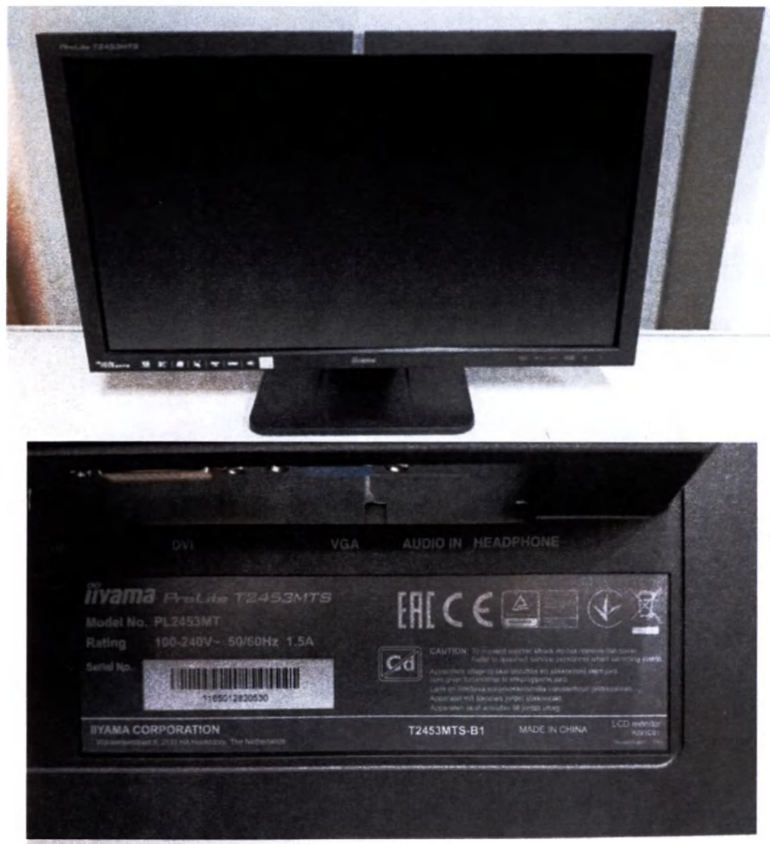
Фотография 44 – Монитор серии ProLite. Пример маркировки.
