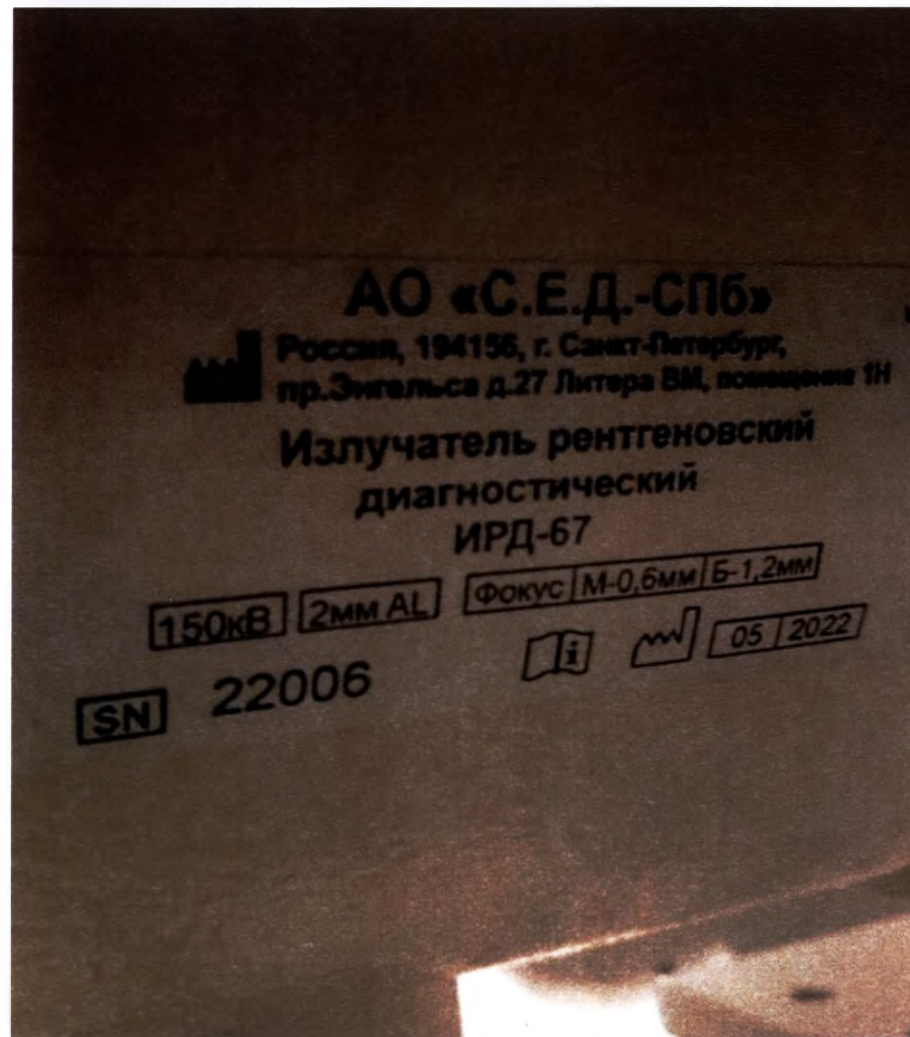
Фотография 15 – Пример маркировки излучателя рентгеновского серии ИРД
