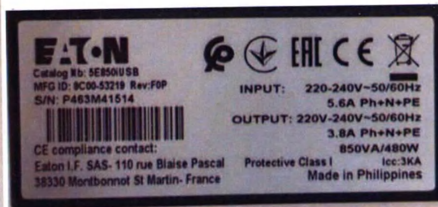
Фотография 59 – Источник бесперебойного питания Eaton. Маркировка
