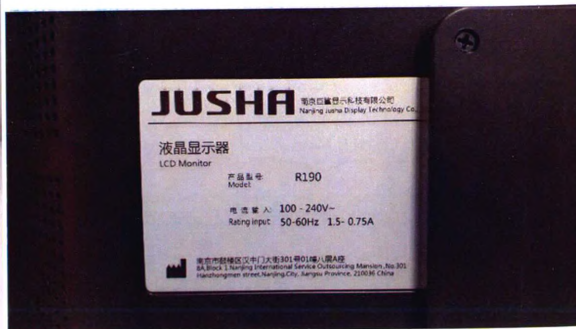
Фотография 49 – Монитор Jusha серии R. Маркировка.
