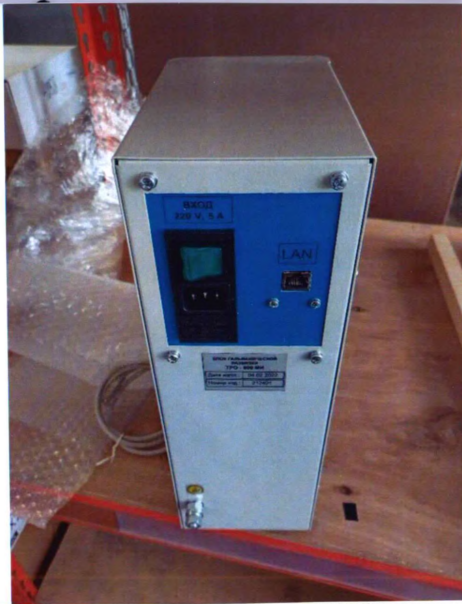
Фотография 62 – Блок гальванической развязки ТРО – 600 МИ (вариант внешнего вида)
