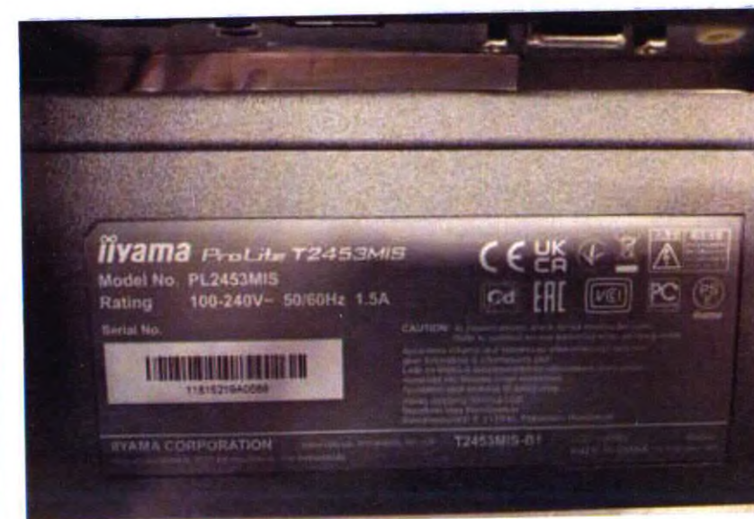
Фотография 53 – Монитор серии ProLite T2453MTS и ProLite T2453MIS и маркировка
