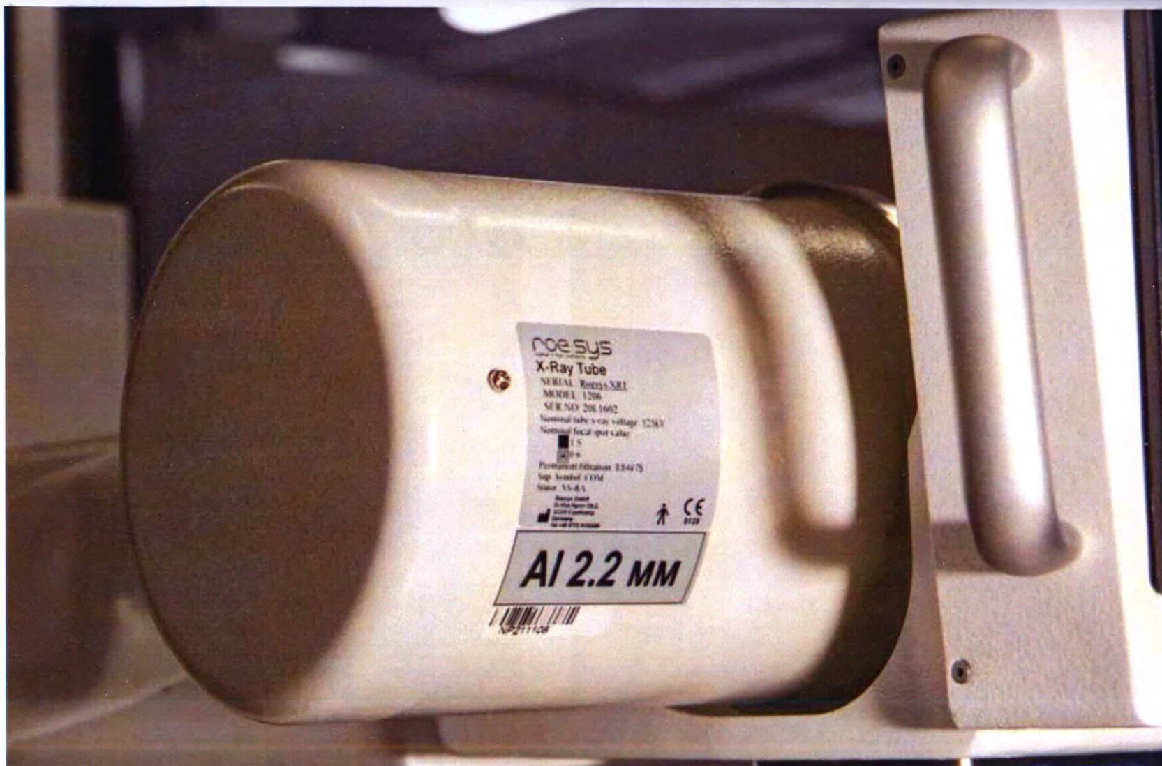
Фотография 16 – Маркировка излучателя рентгеновского серии Roesys
