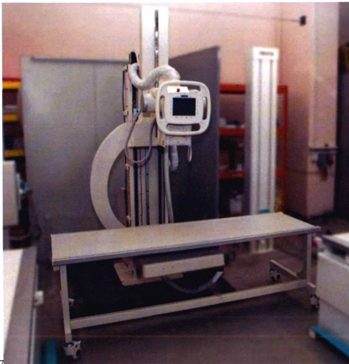
Фотография 2 – Аппарат рентгенографический цифровой АРЦ-ОКО. Вариант общего вида в комплектации Штатив поворотный U-DRC в комплектации с кронштейном в сборе с излучателем рентгеновским серии ИРД, коллиматор серии Ralco R, а также Стол-каталка SUR-10
