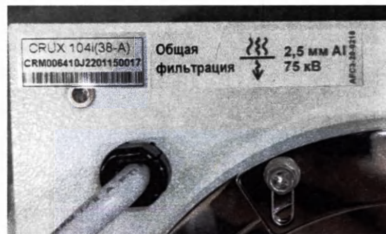
г) - Пример маркировки коллиматора серии CRUX
