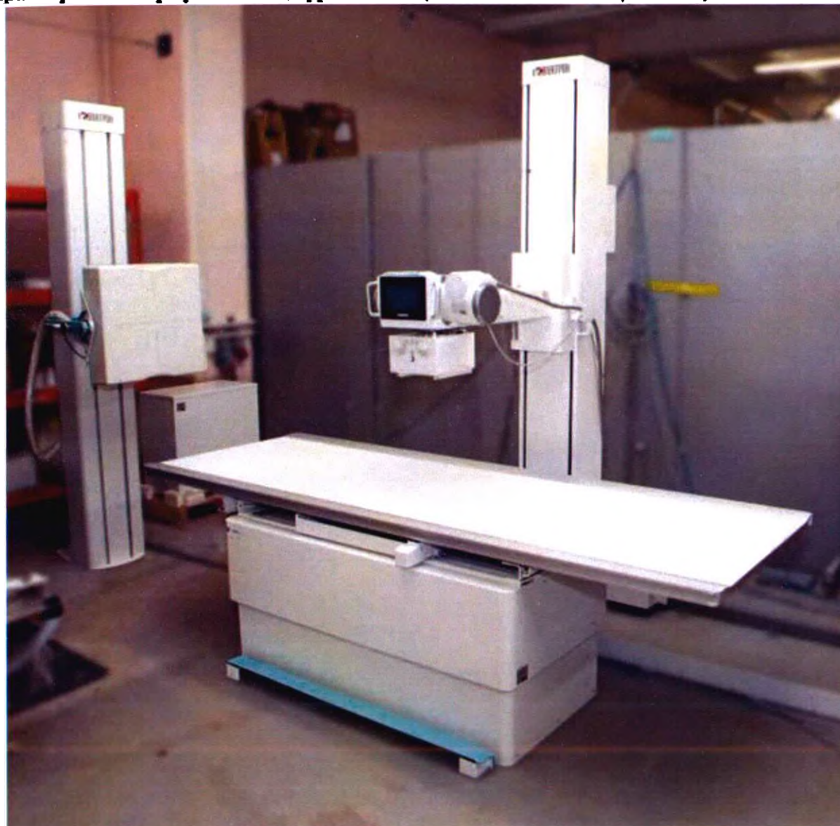
Фотография 1 – Аппарат рентгенографический цифровой АРЦ-ОКО, GP0005427 в комплектации Стол со штативом снимков ТОМОС в исполнении ТОМОС-ДЕ и Стойка снимков СС в исполнении СС-ДП, кронштейн в сборе с излучателем рентгеновским серии ИРД, коллиматор серии CRUX
