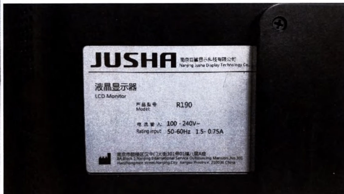
Фотография 40 – Монитор Jusha серии R. Пример маркировки.
