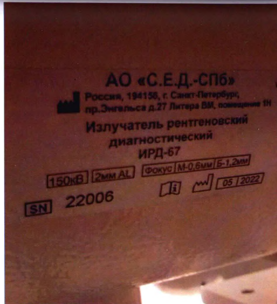
Фотография 18 – Маркировка излучателя рентгеновского серии ИРД
