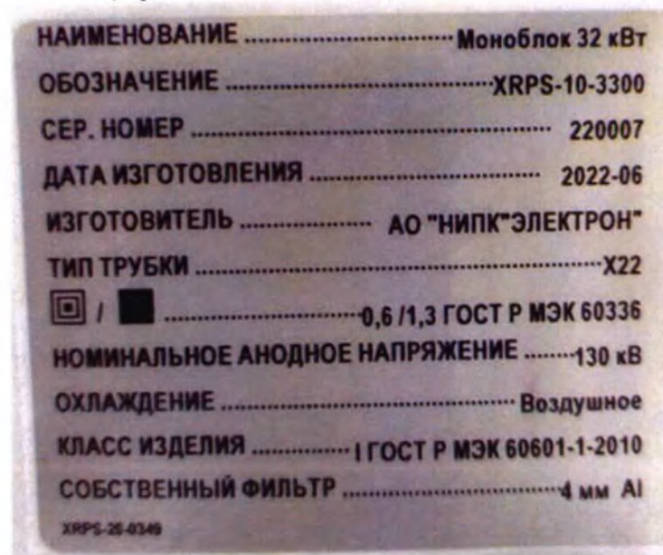
Фотография 13 – Маркировка излучателя рентгеновского XRPS по спецификации моноблок с трубкой IAE
