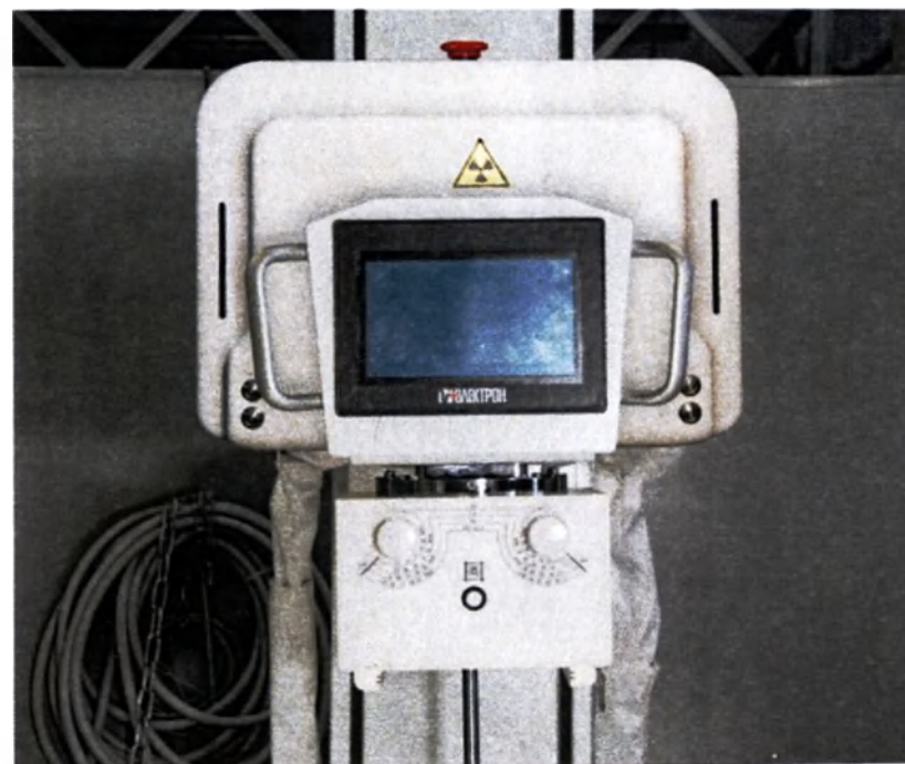
Фотография 12 – Кронштейн с излучателем в сборе RTOMO-10, по спецификации в варианте комплектности с коллиматором серии CRUX и и излучателем рентгеновским XRPS
