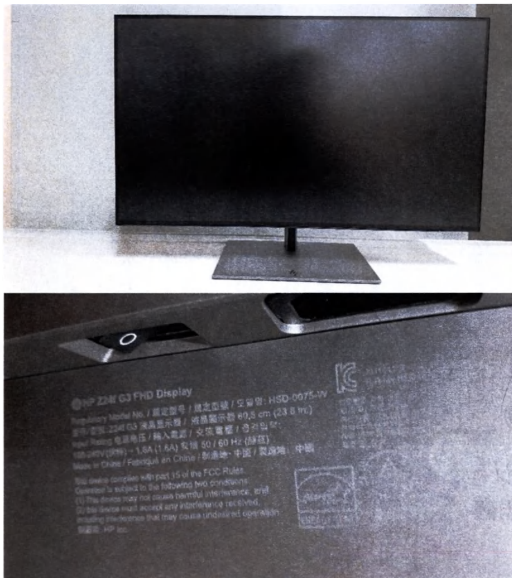
Фотография 49 – Монитор серии HP. Пример маркировки.
