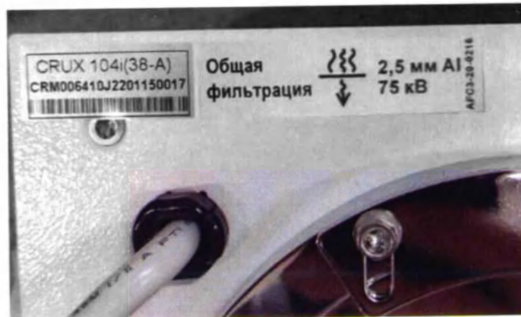
г) Маркировка коллиматора серии CRUX
