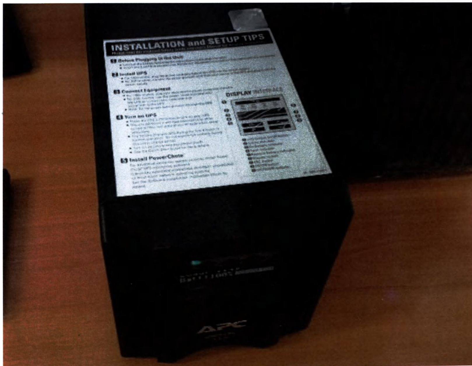
Фотография 52 – Источник бесперебойного питания APC. Пример маркировки.
