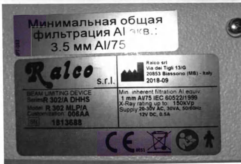
а) - Маркировка коллиматора серии R 302/A DHHS
