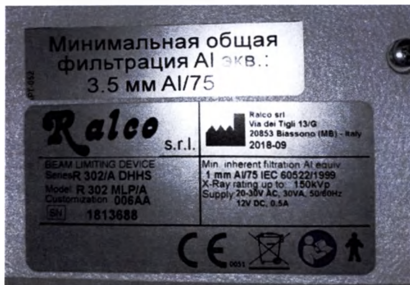
а) - Пример маркировки коллиматора серии R 302/A DHHS
