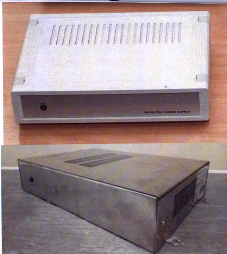
Фотография 40 – Блок питания камеры (детектора)
