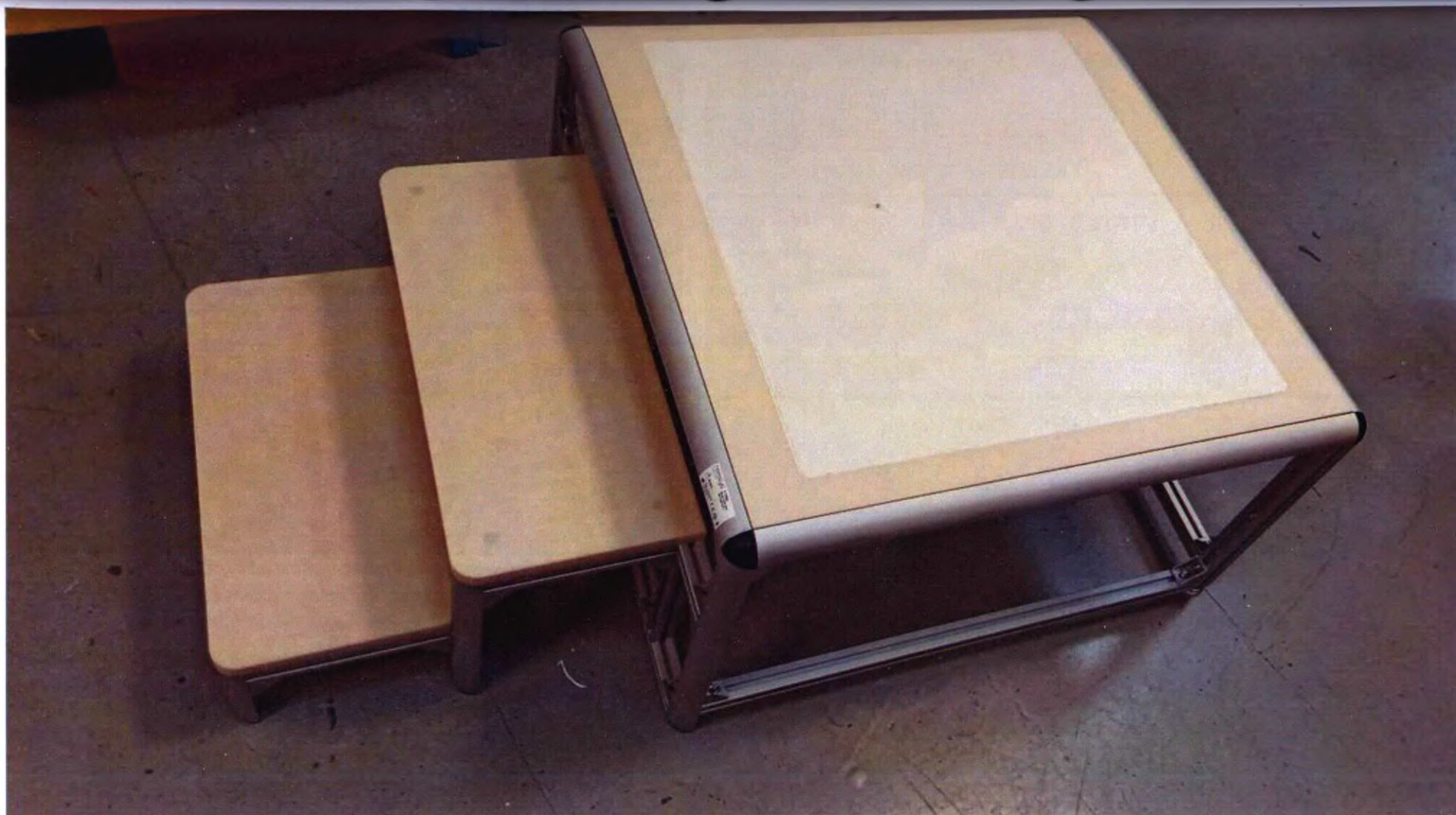
Фотография 24 – Система позиционирования рентгеновская согласно п.4.1 таблицы комплектности ТУ (вариант внешнего вида)
