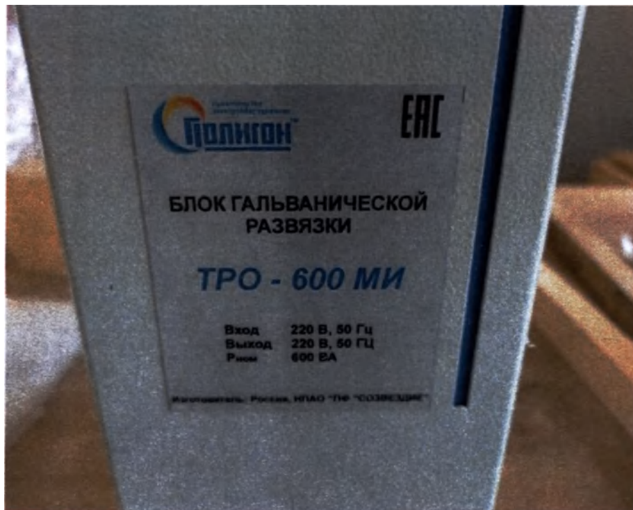
Фотография 54 – Блок гальванической развязки ТРО – 600 МИ. Пример маркировки
