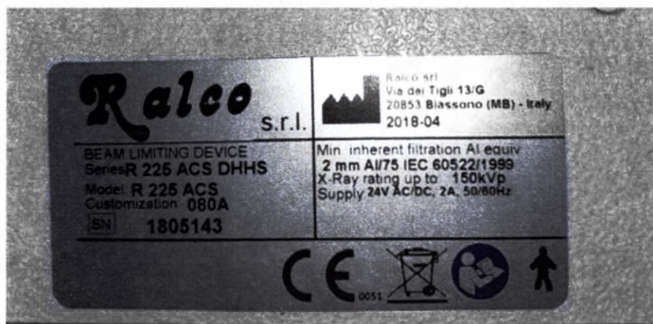
в) - Пример маркировки коллиматора серии R 225 ACS DHHS
