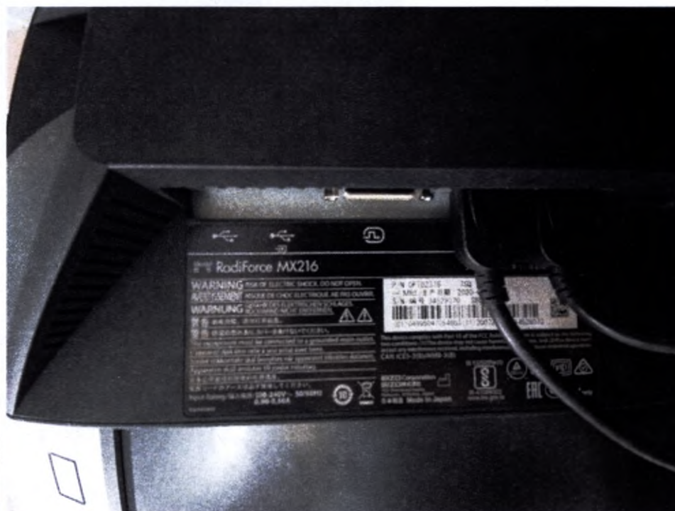
Фотография 45 – Монитор серии RadiForce. Пример маркировки.
