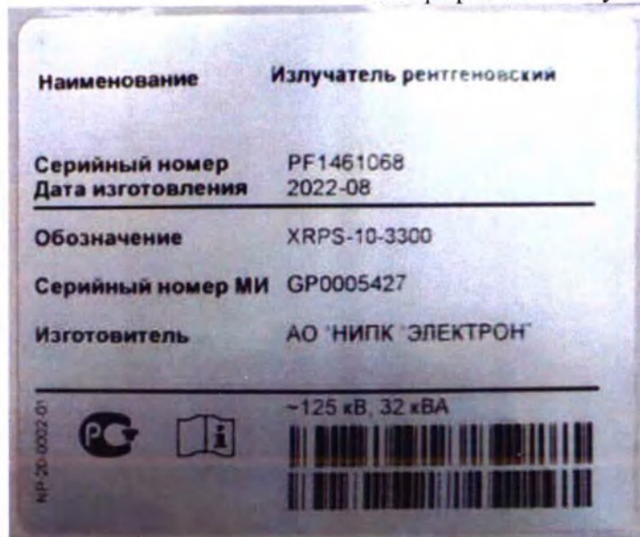
Фотография 12 – Излучатель рентгеновский XRPS (вариант внешнего вида)
