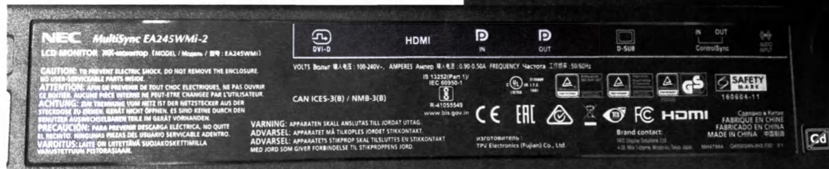
Фотография 47 – Монитор серии NEC. Пример маркировки.
