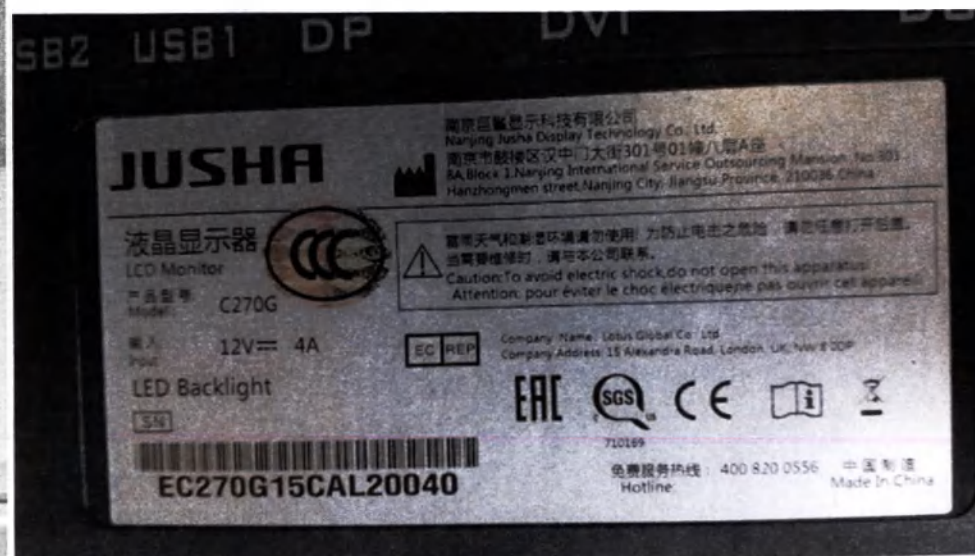
Фотография 41 – Монитор Jusha серии C. Пример маркировки.
