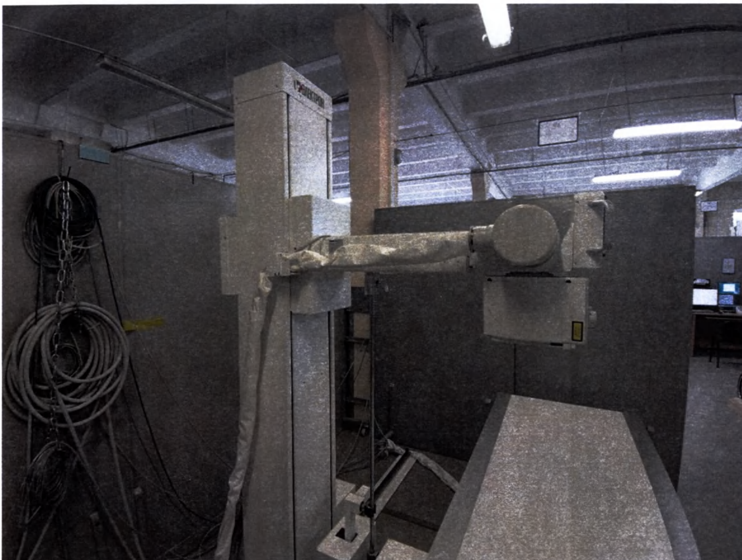
Фотография 2 – Штатив ARC1-10 по спецификации, включающей систему позиционирования рентгеновскую в варианте комплектности со штативом снимков ТОМОС
