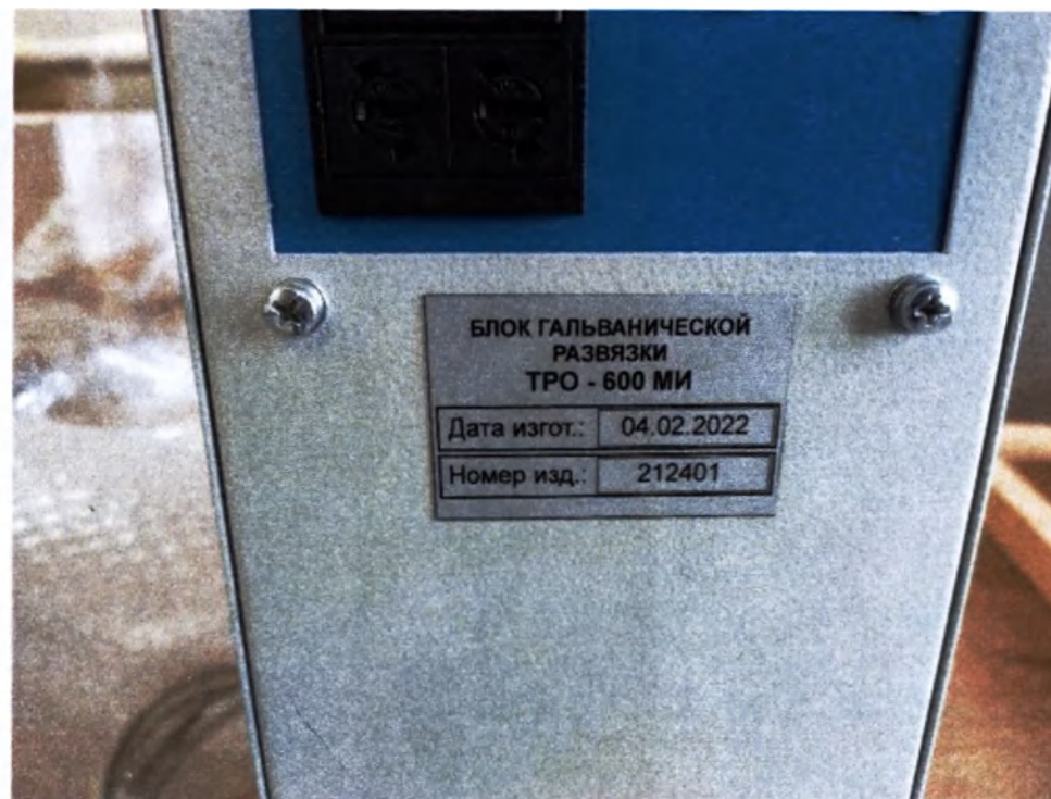
Фотография 54 – Блок гальванической развязки ТРО – 600 МИ. Пример маркировки
