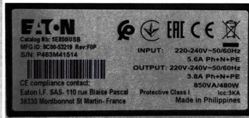
Фотография 50 – Источник бесперебойного питания Eaton. Пример маркировки.
