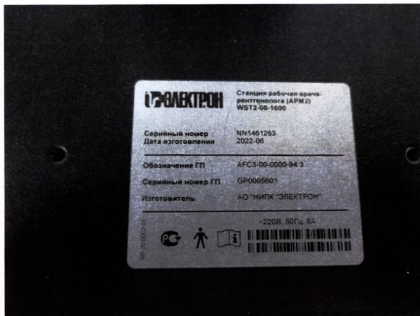
Фотография 38 – Станция рабочая врача-рентгенолога (АРМ2). Пример маркировки.
