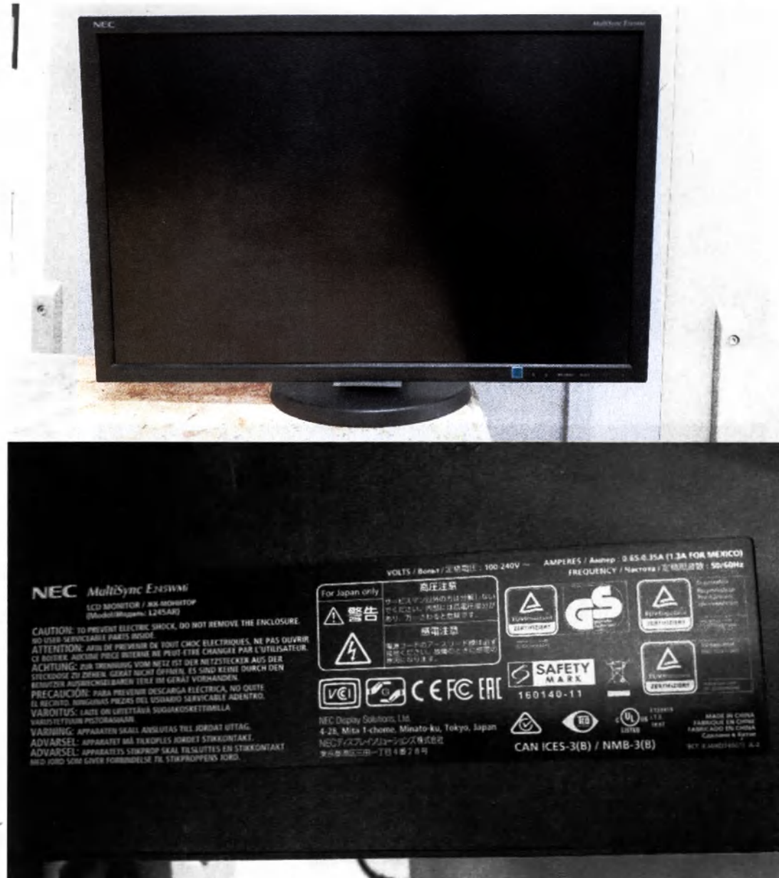
Фотография 48 – Монитор серии NEC. Пример маркировки.
