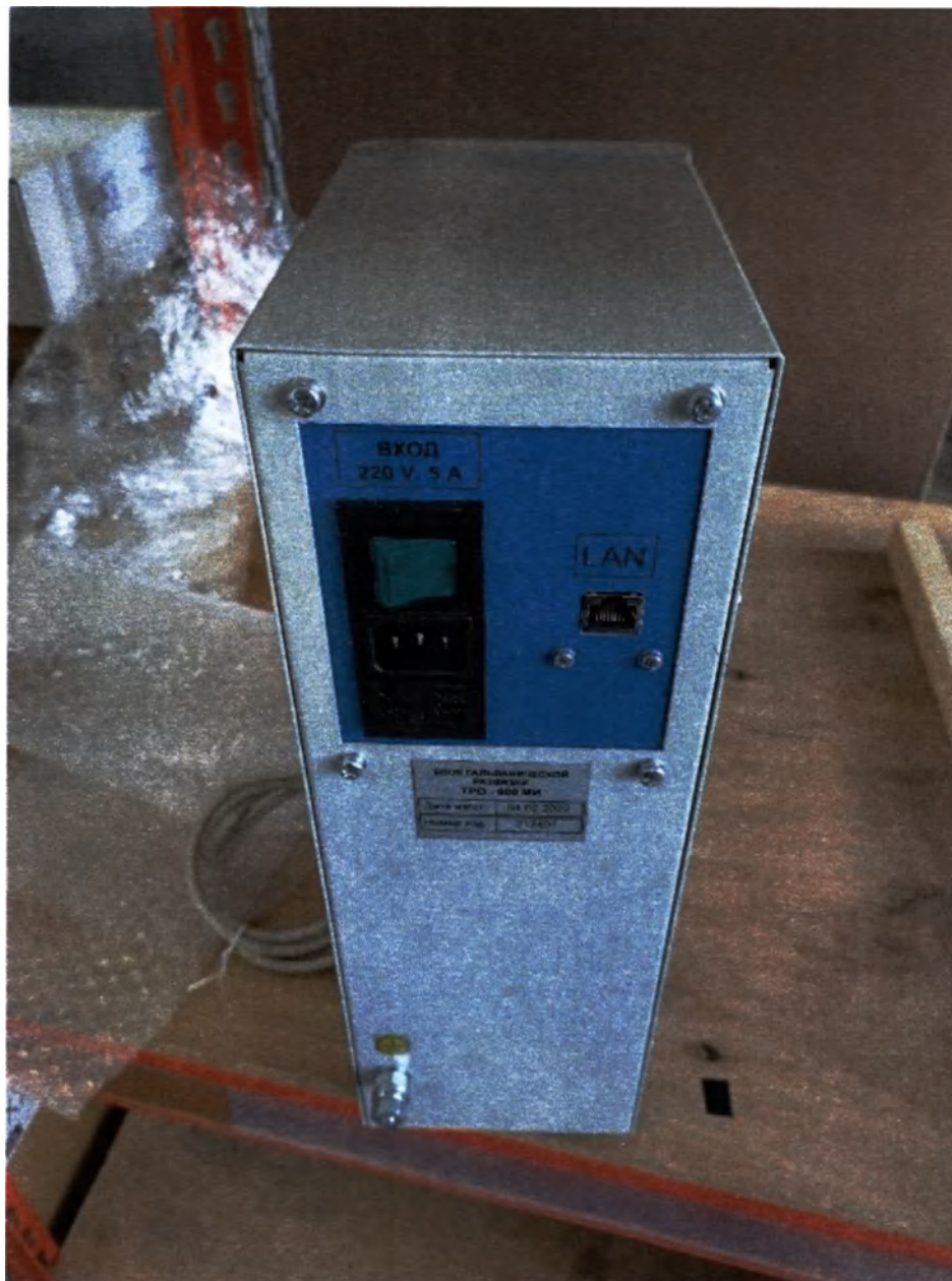
Фотография 53 – Блок гальванической развязки ТРО – 600 МИ (вариант внешнего вида)
