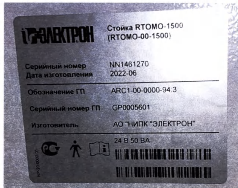
б) - пример маркировки стойки RTOMO-1500
