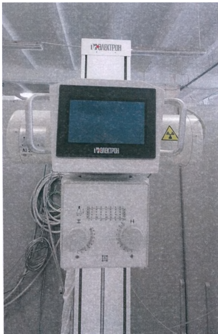
Фотография 14 – Кронштейн с излучателем в сборе RTOMO-10, по спецификации в варианте комплектности с коллиматором серии Ralco R 302/A DHHS и излучателем рентгеновским серии Roesys
