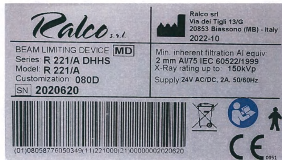
б) - Маркировка коллиматора серии R 221/A DHHS
