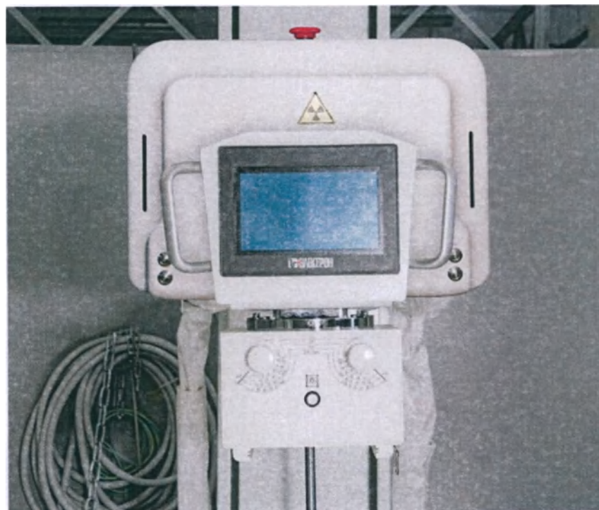
Фотография 15 – Кронштейн с излучателем в сборе RTOMO-10, по спецификации в варианте комплектности с коллиматором серии CRUX и и излучателем рентгеновским XRPS
