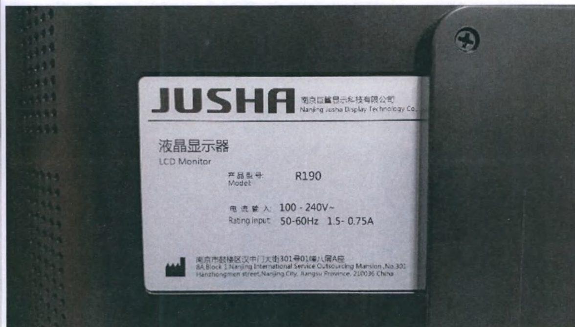
Фотография 48 – Монитор Jusha серии R. Маркировка.
