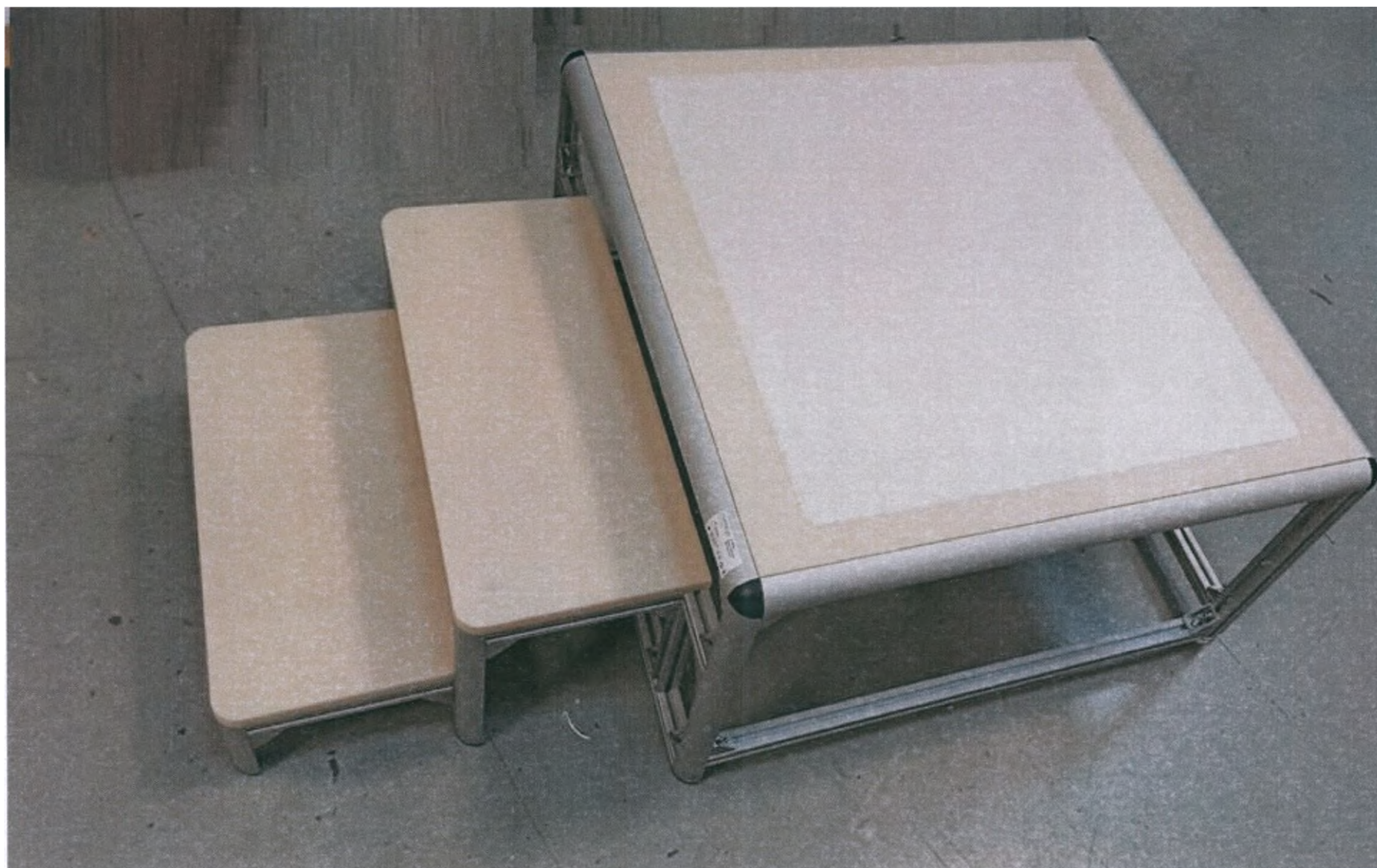
Фотография 24 – Система позиционирования рентгеновская согласно п.4.1 таблицы комплектности ТУ (вариант внешнего вида)
