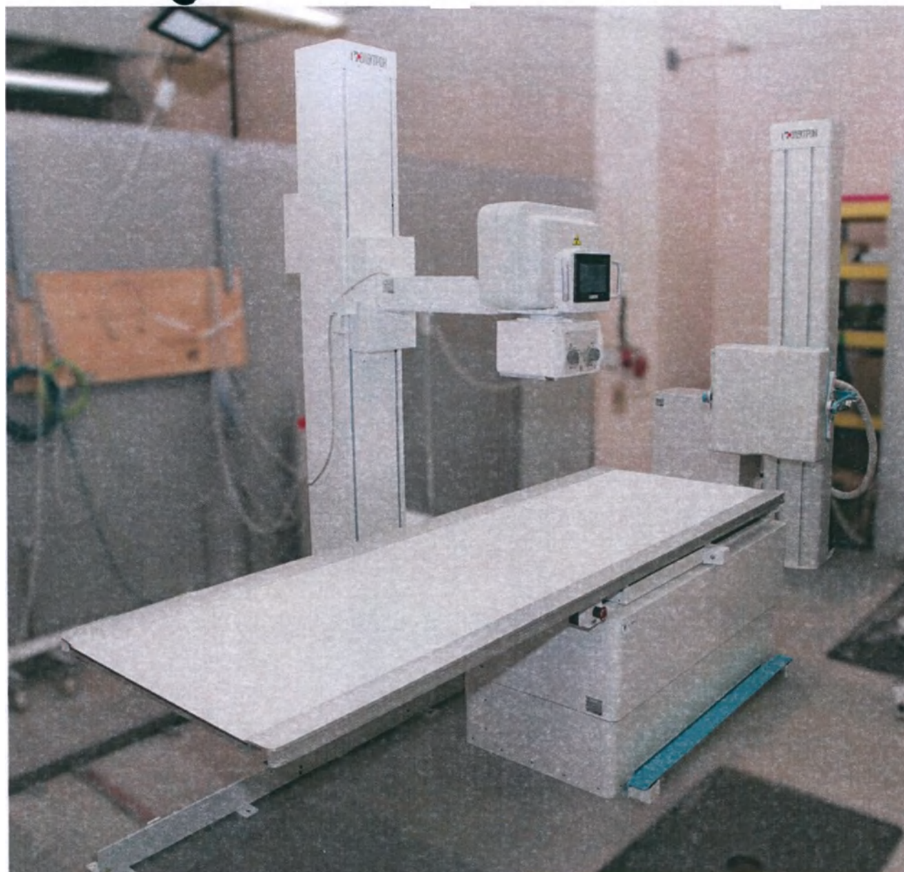
Фотография 1.1 – Аппарат рентгенографический цифровой АРЦ-Максима, GP0005426 в комплектации Стол со штативом снимков ТОМОС в исполнении ТОМОС-ДЕ и Стойка снимков СС в исполнении СС-ДП, в комплектации с излучателем рентгеновским серии XRPS
