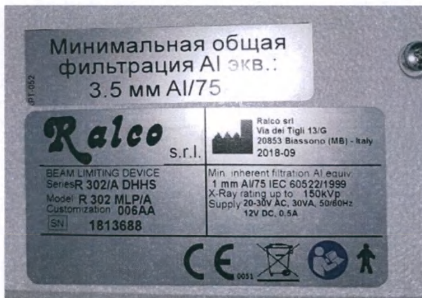
а) - Маркировка коллиматора серии R 302/A DHHS
