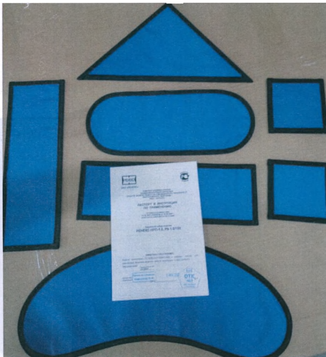
Фотография 78 – Образцы из Комплекта индивидуальных поливинилхлоридно-свинцовых средств защиты пациентов и медицинского персонала от рентгеновского излучения № ФСП 2008/03184, ЗАО «Ренекс»
