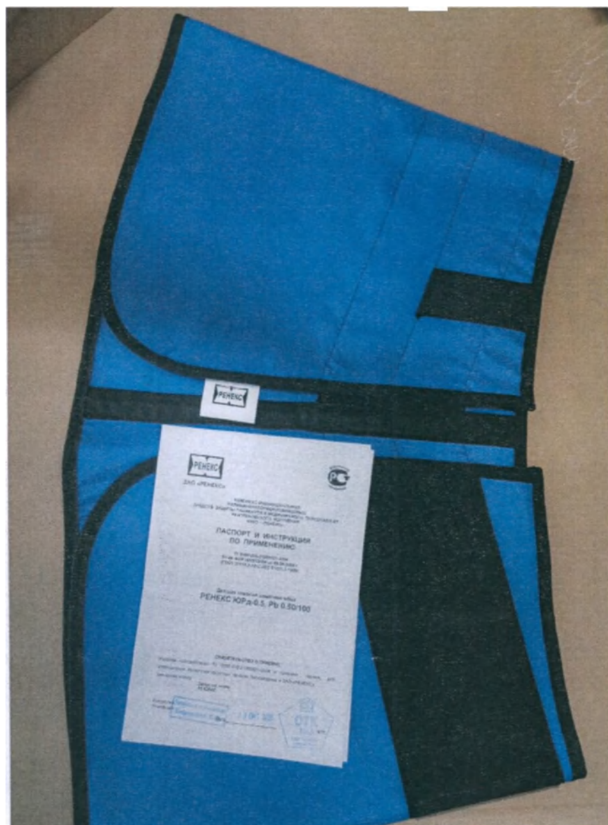
Фотография 78 – Образцы из Комплекта индивидуальных поливинилхлоридно-свинцовых средств защиты пациентов и медицинского персонала от рентгеновского излучения № ФСП 2008/03184, ЗАО «Ренекс»
