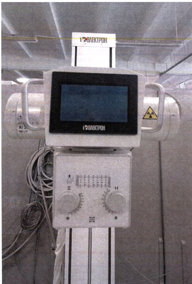
Фотография 14 – Кронштейн с излучателем в сборе RTOMO-10, по спецификации в варианте комплектности с коллиматором серии Ralco R 302/A DHHS и излучателем рентгеновским серии Roesys
