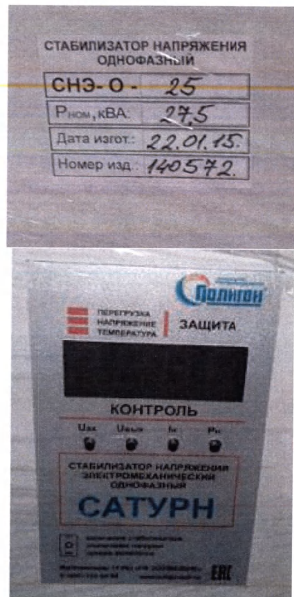
Фотография 32 – Стабилизатор согласно п.5.2 таблицы комплектности ТУ в варианте комплектования стабилизатором серии СНЭ (вариант внешнего вида)
