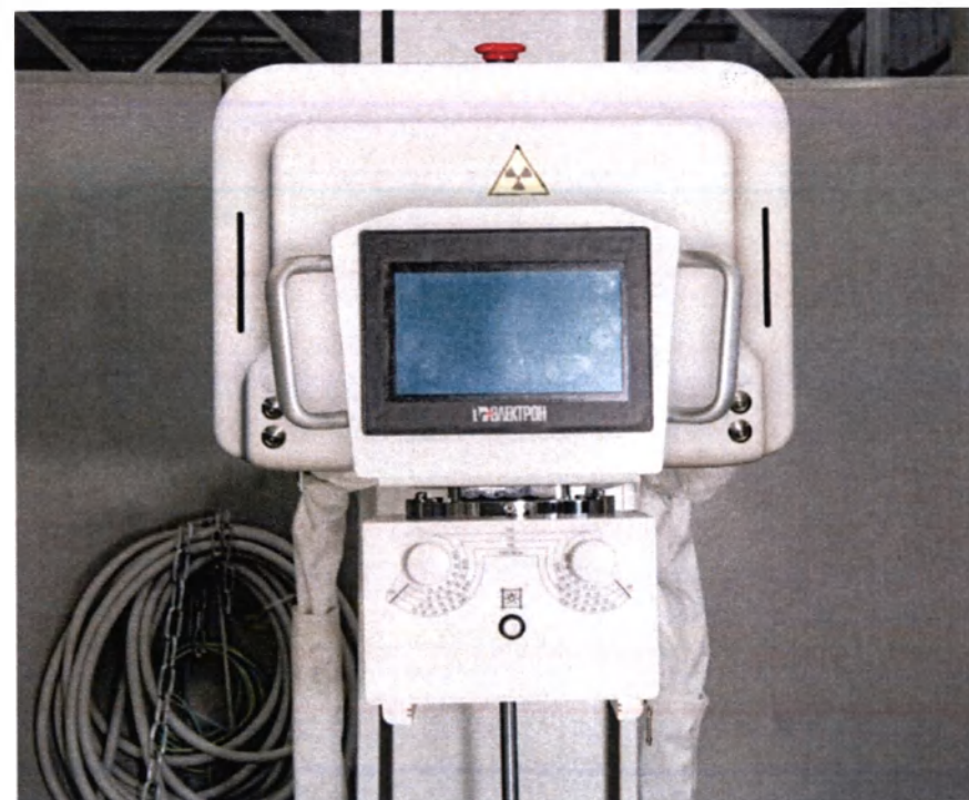
Фотография 15 – Кронштейн с излучателем в сборе RTOMO-10, по спецификации в варианте комплектности с коллиматором серии CRUX и и излучателем рентгеновским XRPS
