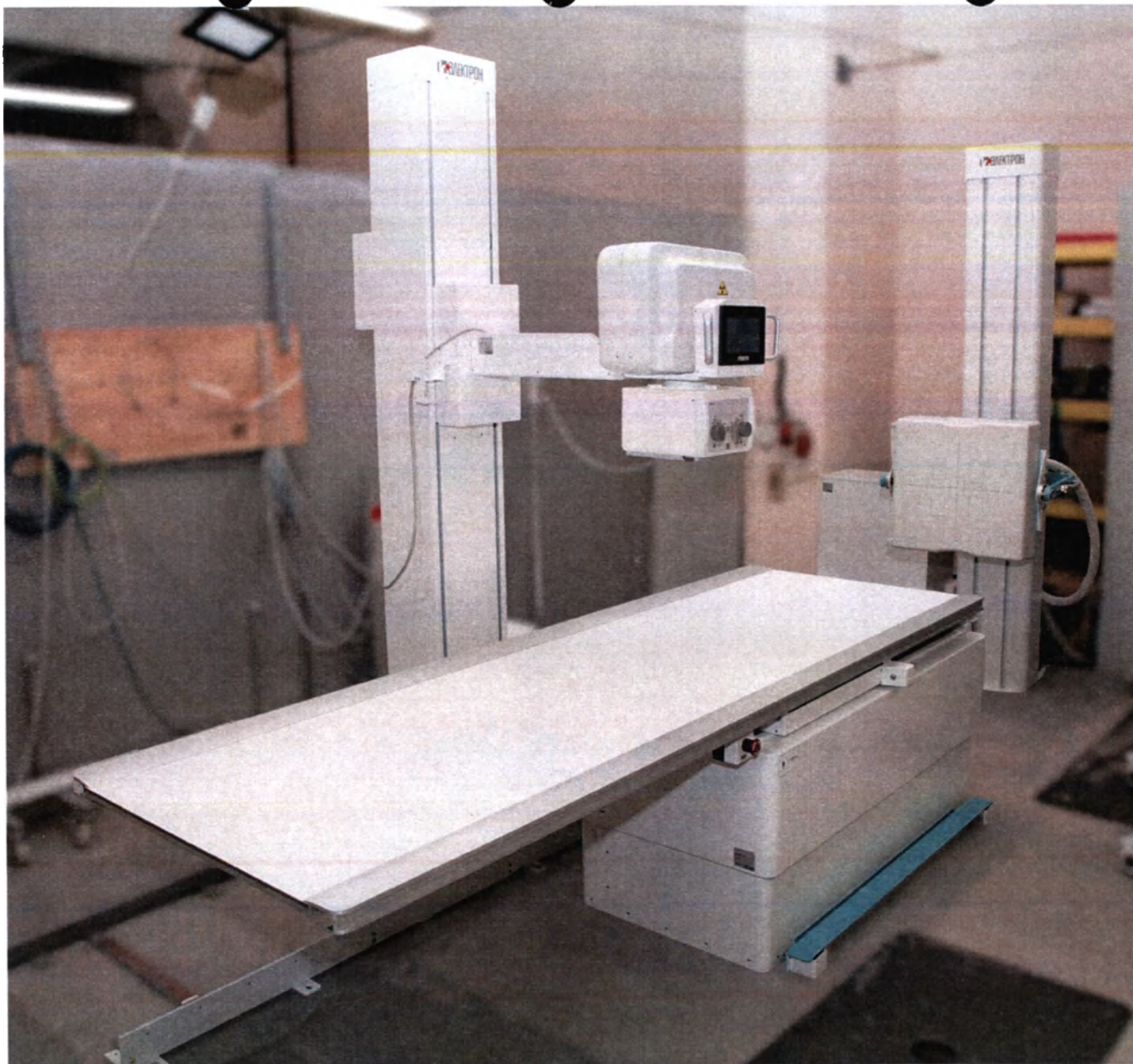
Фотография 1.1 – Аппарат рентгенографический цифровой АРЦ-ЭКСПЕРТ, GR0005428 в комплектации Стол со штативом снимков ТОМОС в исполнении ТОМОС-ДЕ и Стойка снимков СС в исполнении СС-ДП, в комплектации с излучателем рентгеновским серии XRPS и трубкой IAE
