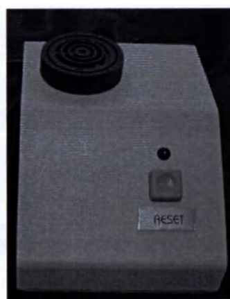
Рис. 3-59: Блок управления сигнальной системой для пациента. Вариант 1: кнопка Steady/Pulse (Постоянный/Импульсный режим) слева, а кнопка Reset (Сброс) справа. Вариант 2: кнопка Reset (Сброс).
