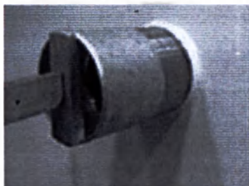
Рис. 2-66: Инструмент для удаления вакуума установлен параллельно полу
