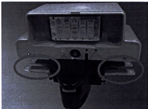
Рис. 3-78: Педали «вверх» и «вниз» по обе стороны от основания магнита
