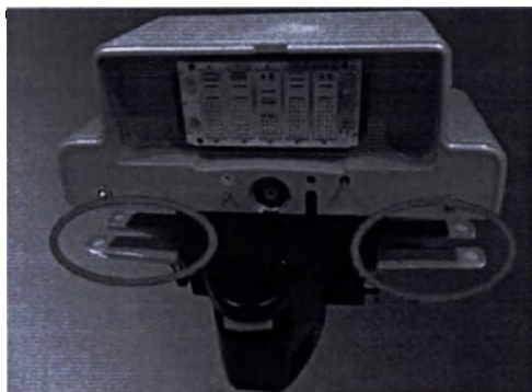
Рис. 4-1: Педали «вверх» и «вниз» по обе стороны от основания магнита
