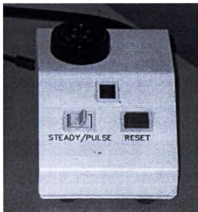
Рис. 3-59: Блок управления сигнальной системой для пациента. Вариант 1: кнопка Steady/Pulse (Постоянный/Импульсный режим) слева, а кнопка Reset (Сброс) справа. Вариант 2: кнопка Reset (Сброс).
