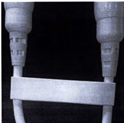
Рис. 3-102: Направляющие для кабеля системы используются для предотвращения образования петель
