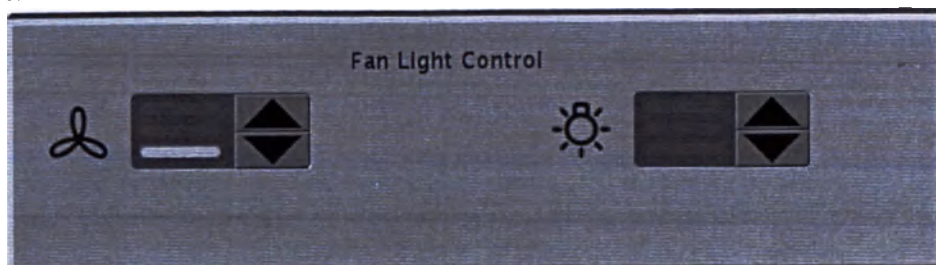
Рис. 3-54: Область управления вентилятором и освещением на экране управления синхронизацией, вентилятор на низком уровне и освещение выключено
