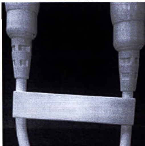
Рис. 3-110: Направляющие для кабеля системы используются для предотвращения образования петель
