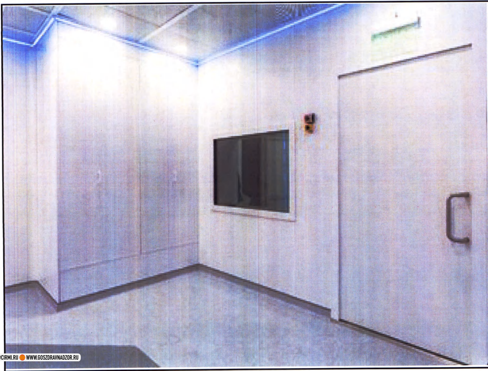
34. Устройство для защитного экранирования помещения (Клетка Фарадея).
