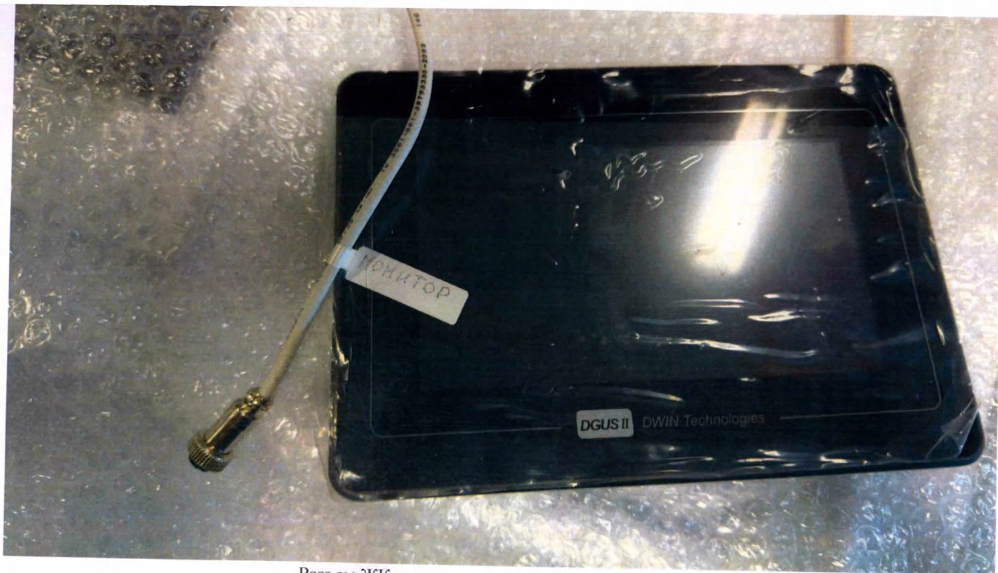
Разъем ЖК монитора с системой управления
