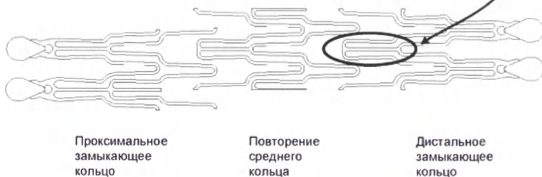
Рисунок 4. Конструкция стента Absolute Pro (Справочный чертёж)
