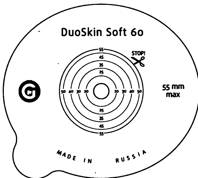
Рис. 10 Макет маркировки варианта исполнения: 10. ДуоСкин Софт: пластина плоская, вырезаемое отверстие 10-55 мм, фланец 60 мм (вид 221850).
