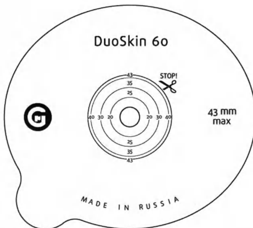
Рис. 7 Макет маркировки варианта исполнения: 7. ДуоСкин: пластина конвексная, вырезаемое отверстие 10-43 мм, фланец 60 мм (вид 221840).
