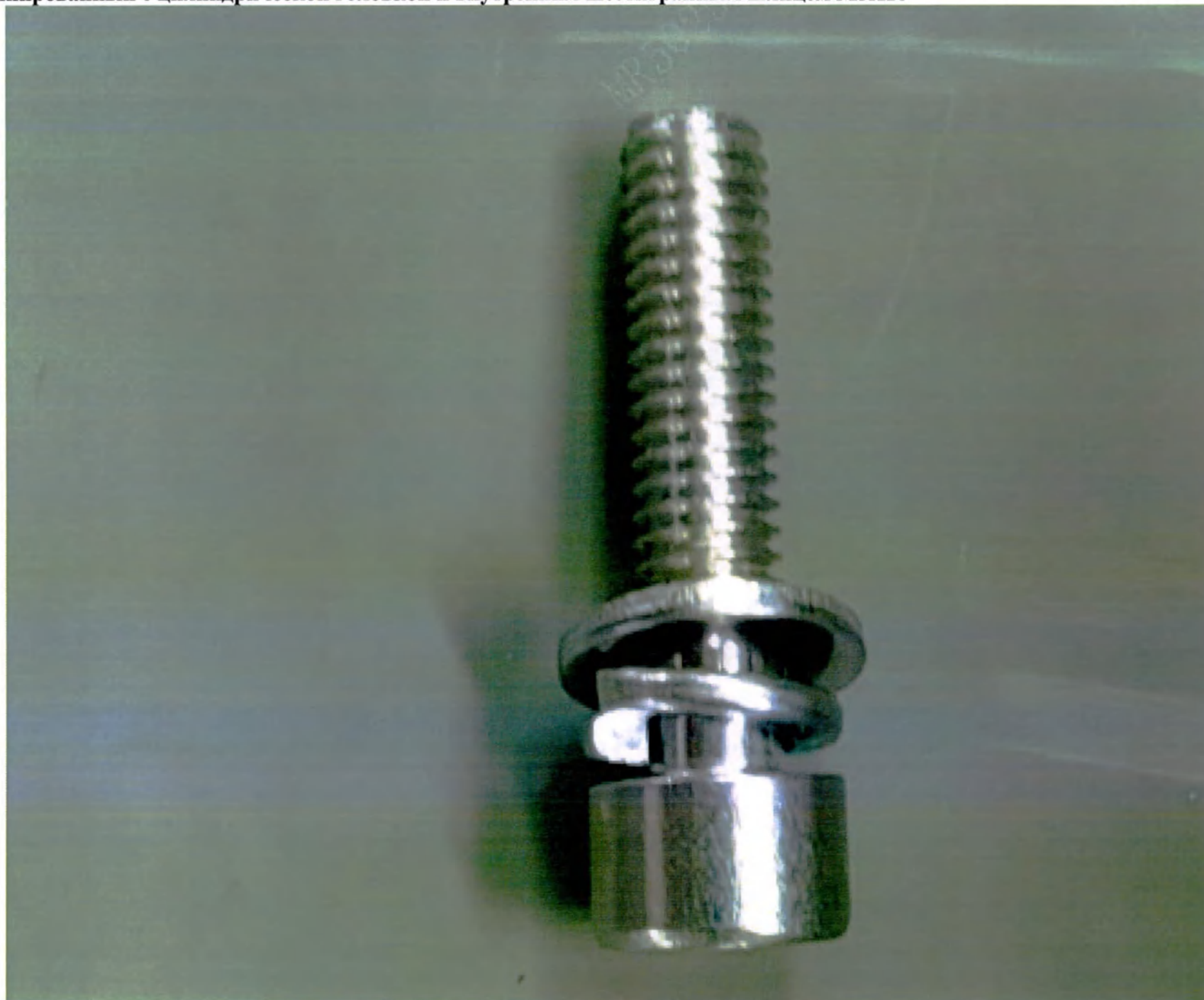
Винт комбинированный с цилиндрической головкой и внутренним шестигранным шлицем M5X16
