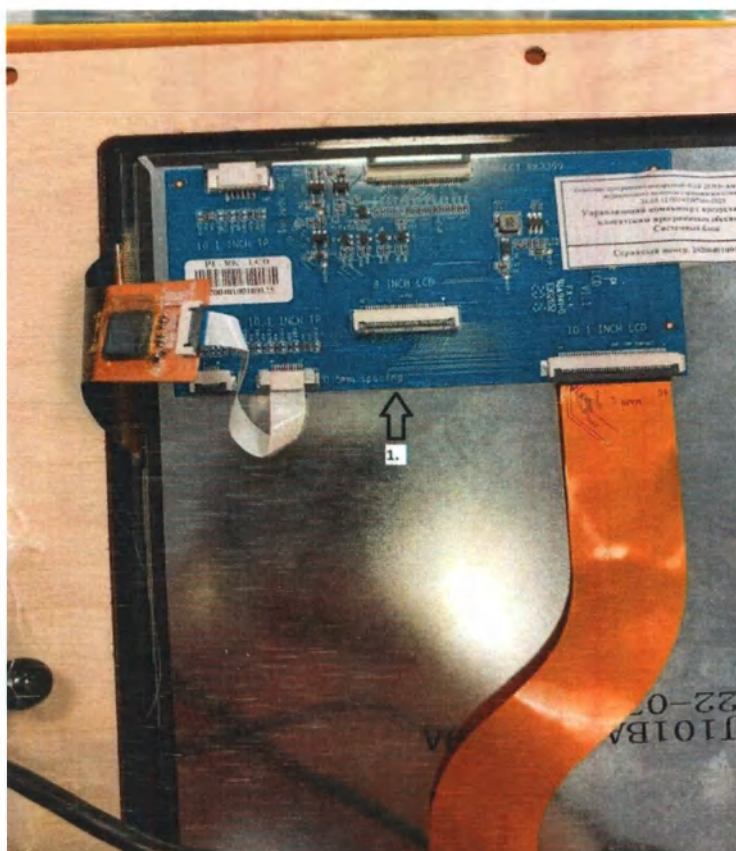
Рисунок 5 - Комплекс программно-аппаратный «ПАК ДОМ» для дистанционного медицинского контроля, в варианте исполнения: «Настольный с переносным кейсом». Управляющий компьютер, встроенный.
