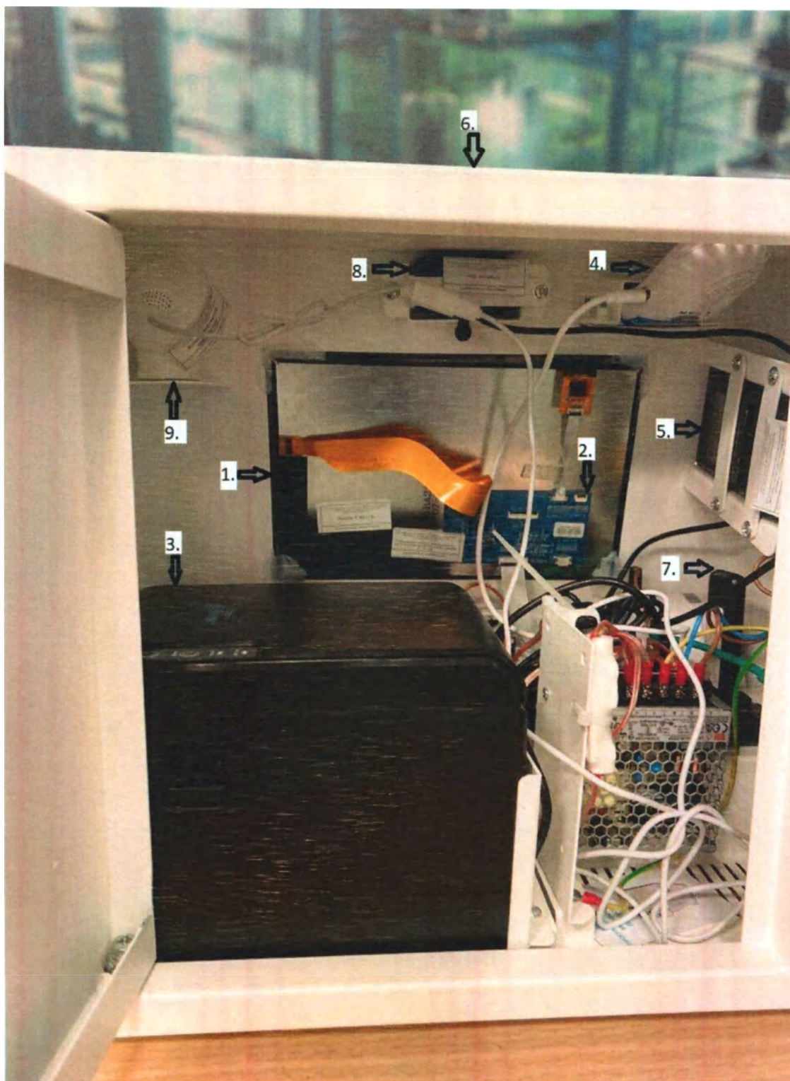
Рисунок 12- Комплекс программно-аппаратный «ПАК ДОМ» для дистанционного медицинского контроля, в варианте исполнения: «Настольный в корпусе». Вид сзади с открытой крышкой
