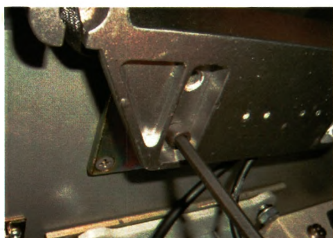
Рис. 28 «крепление кронштейна с помощью винтов»
