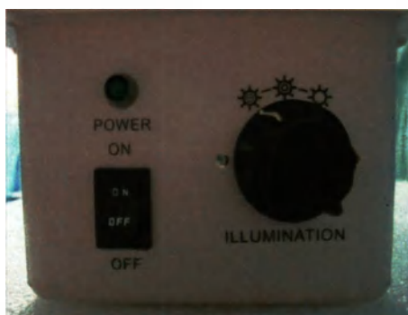
Рис. 11 «Блок включения», где POWER – индикатор включения; ON/OFF – кнопка включения/выключения; ILLUMINATION – кнопка регулировки освещения.
