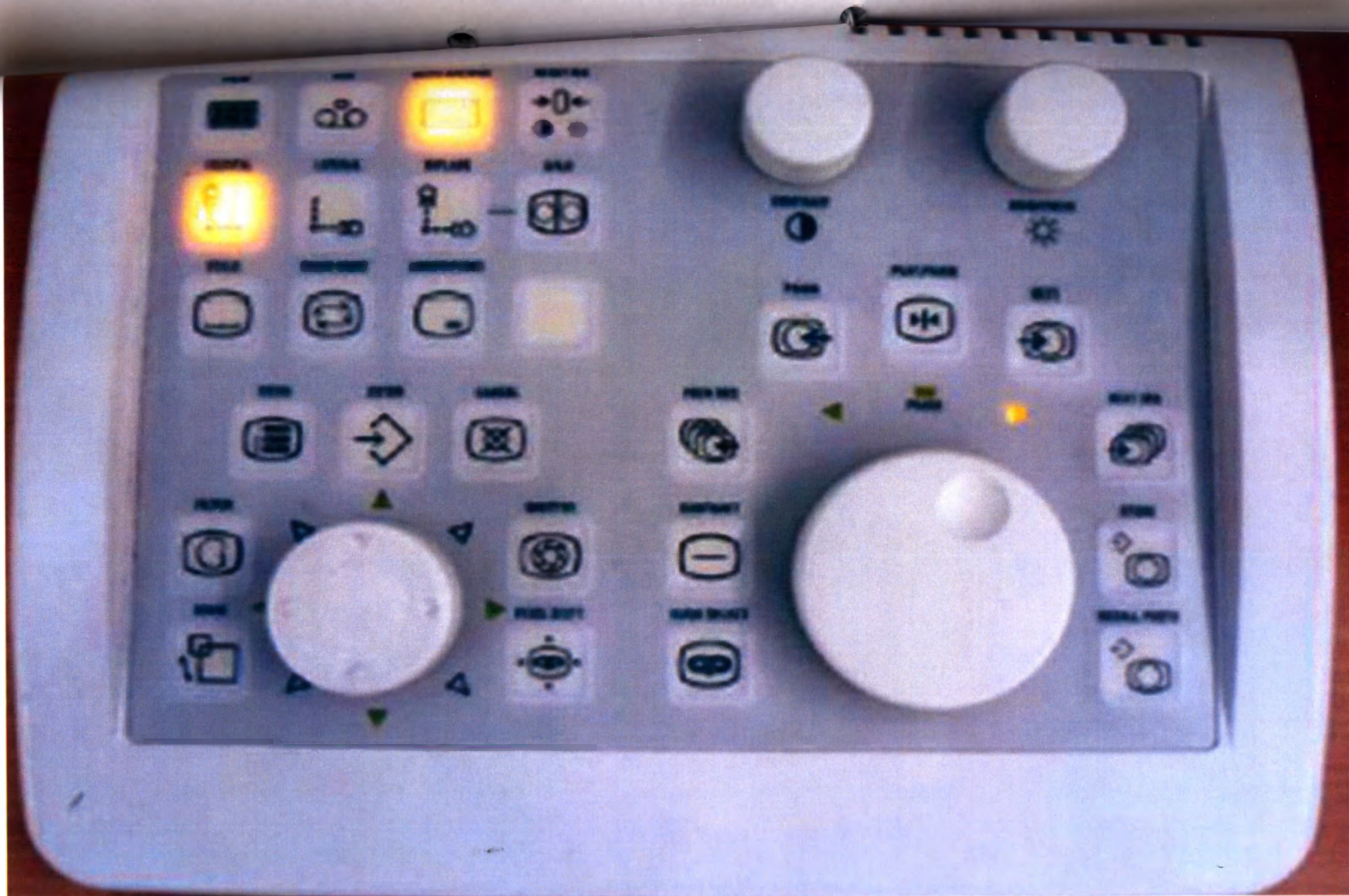
Панели удаленного управления ангиографической системой.
