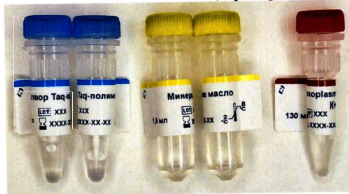
Фасовка S, пробирки. Пробирки с коническим и юбочным основанием (Раствор Taq-полимеразы, Минеральное масло, K+)
