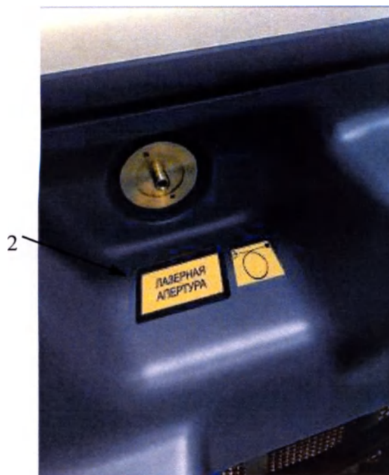
1- Знаки лазерной опасности и обозначение «Класс 4», 2 - Табличка «Лазерная апертура» и символ «Вывод излучения через оптическое волокно».
