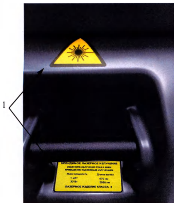
1- Знаки лазерной опасности и обозначение «Класс 4», 2 - Табличка «Лазерная апертура» и символ «Вывод излучения через оптическое волокно».
