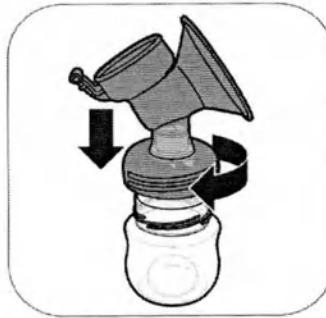
3. Сүтсауғыш корпусын бөтелкеге бұраңыз.
