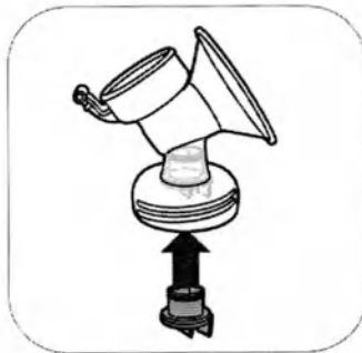
2. Сүтсауғыш корпусындағы ақ клапанды барынша алыс салыңыз.
