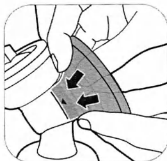
4А. Шұңғыма ішіндегі жастықшаның ішкі бөлігін сызыққа қарсы басыңыз (көрсеткімен көрсетілгендей).
