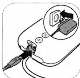
2. Вставьте вилку блока питания в розетку сети, а разъем Micro-USB на другом конце подключите к моторному блоку.
