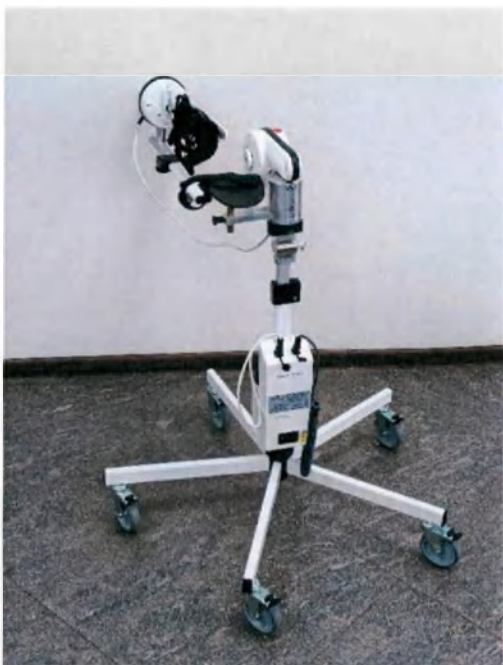
Рисунок 1. 6— Исполнительный механизм разработки локтевого сустава (из состава модели «Орторент-локоть компакт»)
