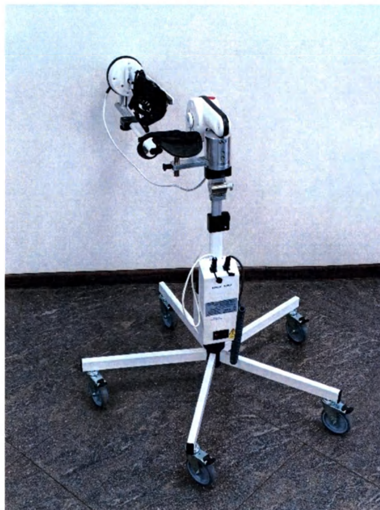
Исполнительный механизм разработки локтевого сустава
