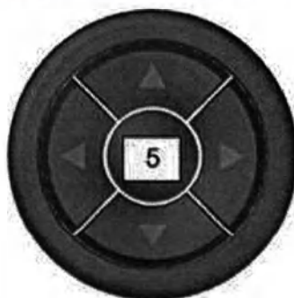
Рисунок 3.36 – Кнопка включения указателя поля рентгеновского излучения
