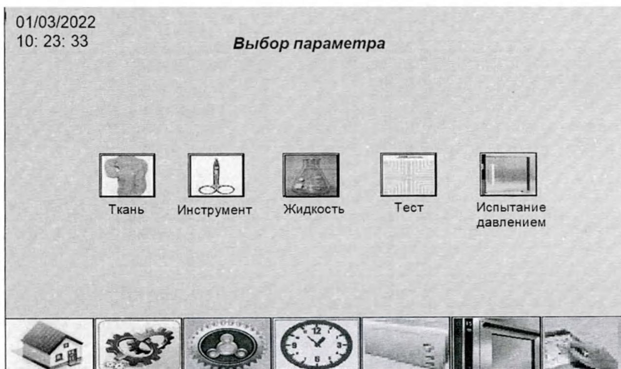
Рисунок 34 – Экран выбора параметра (программы обеззараживания в зависимости от типа медицинских изделий и тестирования автоклава) ПО автоклава модуль 1-200, модуль 1-280. ПО автоклава содержит 3 программы обеззараживания в зависимости от типа медицинских изделий: «Ткань» (рисунок 35), «Инструмент» (рисунок 36), «Жидкость» (рисунок 37) и 2 программы тестирования автоклава: «БД Тест (Бови-Дик)» (рисунок 38) и «Испытание давлением» (вакуумный тест) (рисунок 39).
