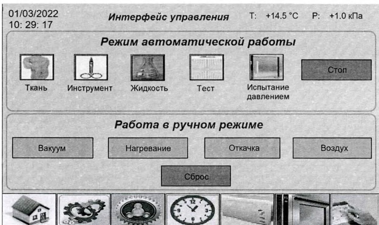
Рисунок 42 – Экран выбора режима управления (автоматического, ручного) ПО автоклава модуль 1-200, модуль 1-280
