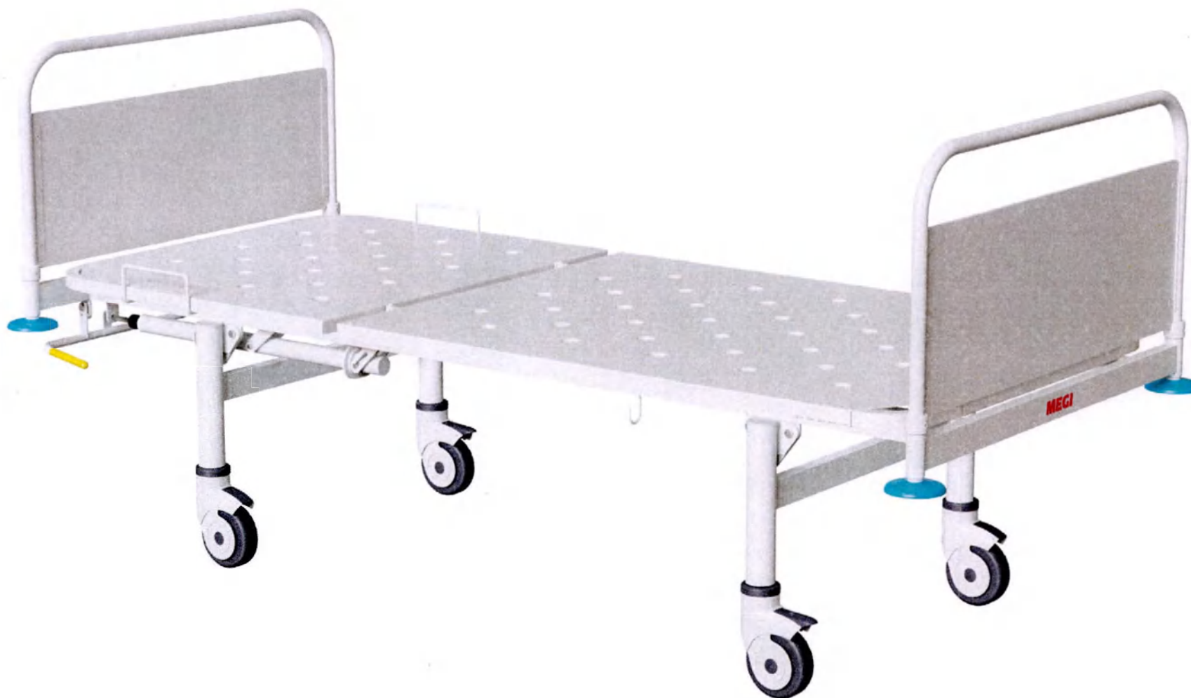
21 КФ0-01-«МСК» (МСК-4101Д) - Кровать общепольничная с подголовником, на колесах, металлические спинки с декоративной вставкой из ЛДСП, ложе — стальной лист, регулирование секции пневмоприводом
