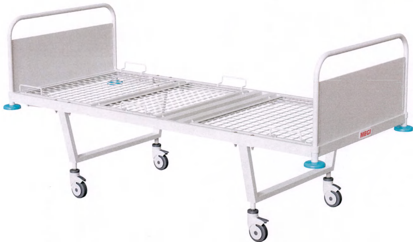
КФЗ-01-«МСК» (МСК-103Д) - Кровать функциональная, на колесах, металлические спинки с декоративной вставкой из ЛДСП, ложе — стальная сетка, механическое регулирование секций (ступенчатая рейка)
