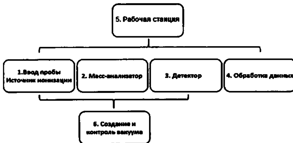
Рисунок 11 – Схема устройства масс-спектрометра
