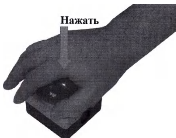
Рис. 6.1. Активация кнопки аварийного останова.
