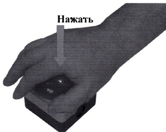
Рис. 6.1. Активация кнопки аварийного останова.
