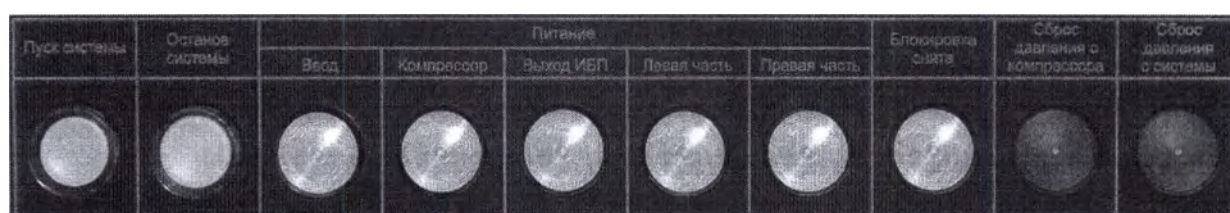
Рис. 3.10. Включен ШВ, включен ИБП, блокировка снята, пуск системы. На данном рисунке показано основное (штатное) состояние индикаторов при включенном тренажёре.
