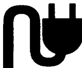
Рисунок 3. Условное обозначение светового индикатора, указывающего на то, что изделие готово к использованию и что используются электрические функции изделия
