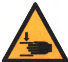
Рисунок 1. Опасность защемления (символ может присутствовать на каркасе стола и на педали регулировки высоты по периметру)
