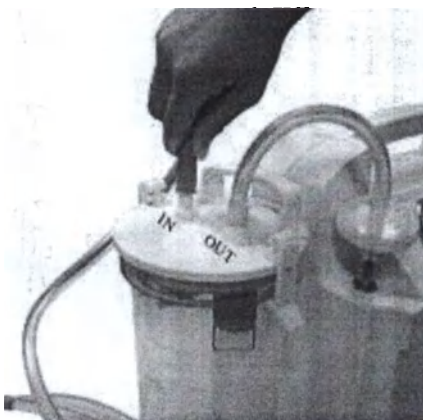
Рис. 10 подсоединение всасывающего шланга
