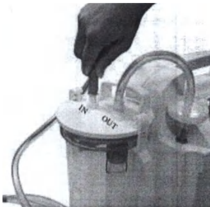
Рис. 10 подсоединение всасывающего шланга
