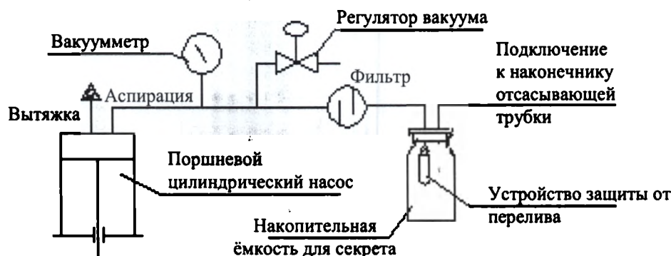
Рис 1. Принципиальная схема работы прибора
