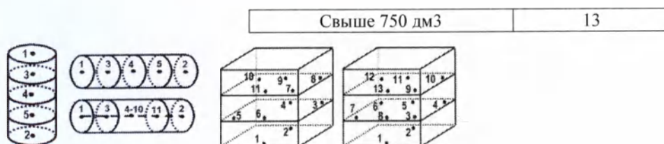
Рис. 1 Расположение контрольных точек в паровых стерилизаторах.
