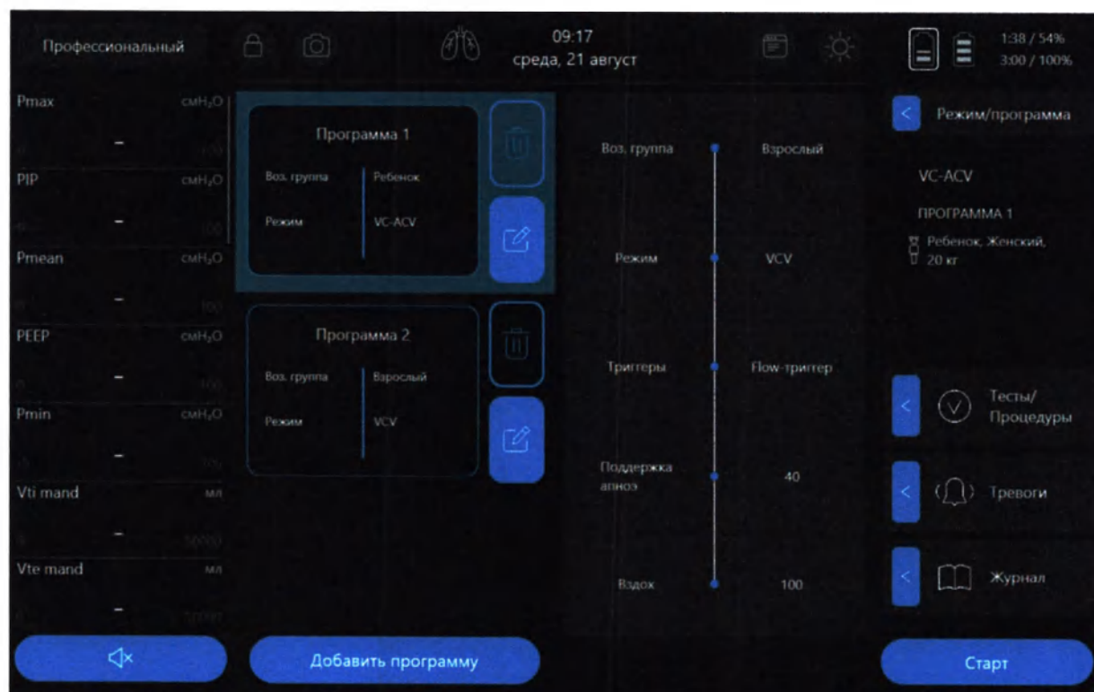
Рисунок 27 – Окно интерфейса для выбора и настройки программы вентиляции
