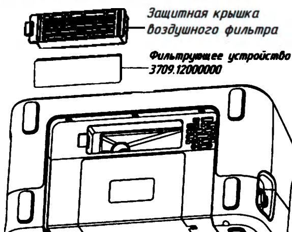
Рисунок 16 – Замена воздушного фильтра на входе в аппарат
