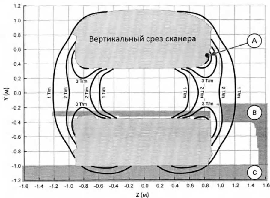
Распределение пространственного градиента магнитного поля B_0 (вид сбоку).
