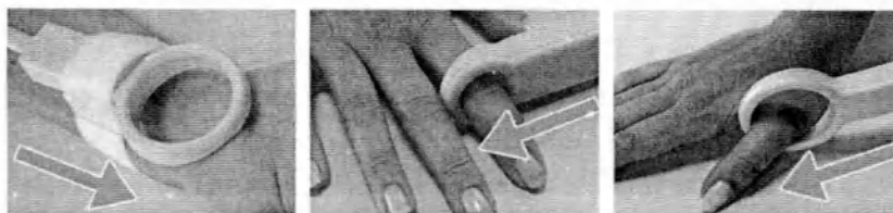
Рис. 157: Примеры расположения катушек Microscopy: на коже, вокруг указательного пальца и вокруг большого пальца. Стрелка указывает ось основного магнитного поля.
