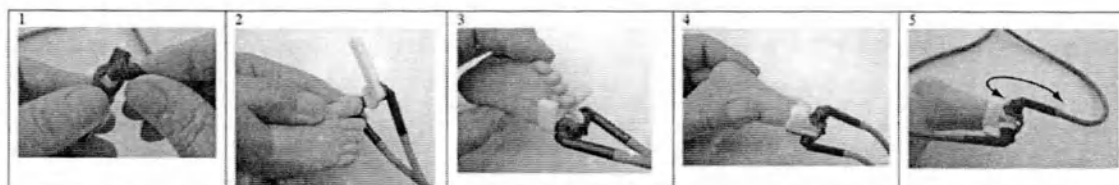
Рис. 160: Установка одноразового зажима I на датчик SpO 2 для модуля PPU.
