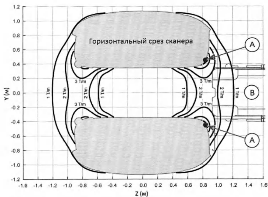
Распределение пространственного градиента магнитного поля B_0 (вид сверху).
