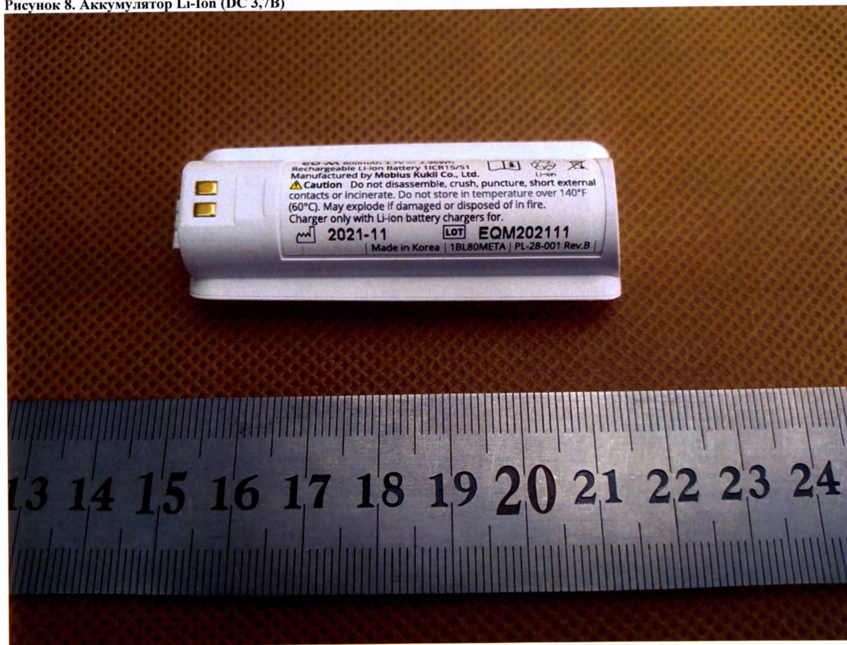
Рисунок 8. Аккумулятор Li-Ion (DC 3,7В)
