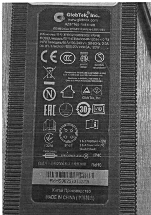
Рис. 15.1.5 – Основная маркировка адаптера питания блока ультразвукового
