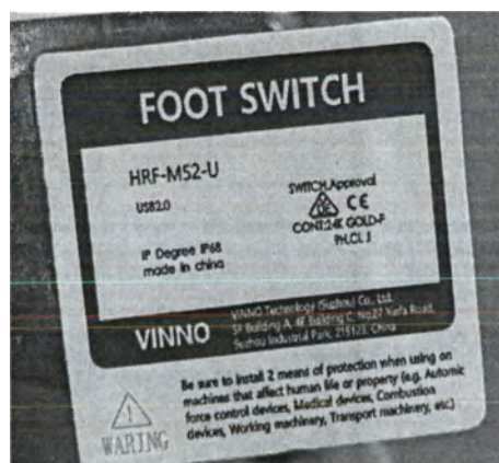
Рис. 15.1.30 – Основная маркировка переключателя ножного HRF-M52-U
