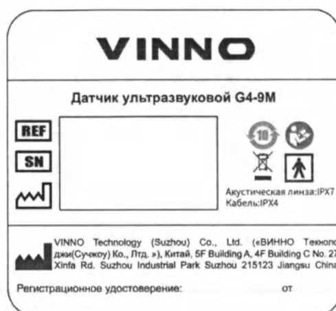
Рис. 15.1.14 - Проект маркировки датчика ультразвукового для всех моделей (на примере датчика УЗ G4-9M)
