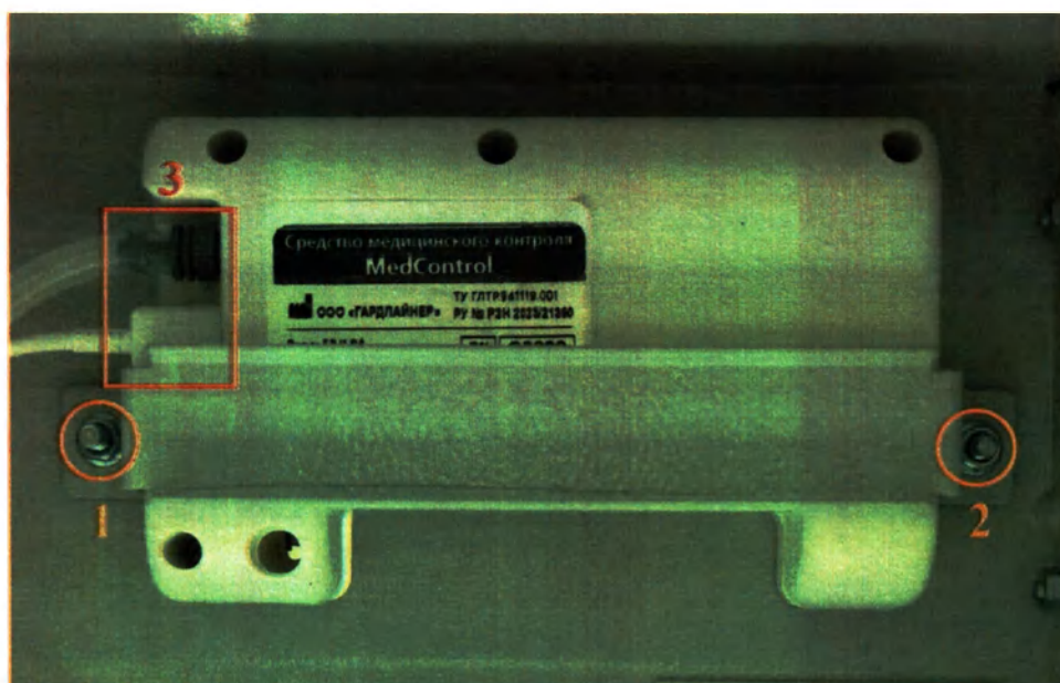
Рисунок 29 – снятие прижимной планки, воздушного шланга и кабеля питания СМК (СИ).
